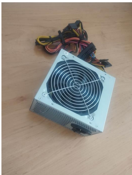
Slika 13. Predodžba PC napajanja. Izvor [Autor].
