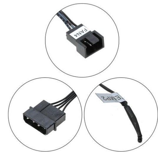
Slika 17. Predodžba temperaturnih senzora i konekcijskih kablova. Izvor [5].
