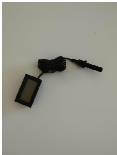
Slika 18. Predodžba LCD termohigrometra. Izvor [Autor].
