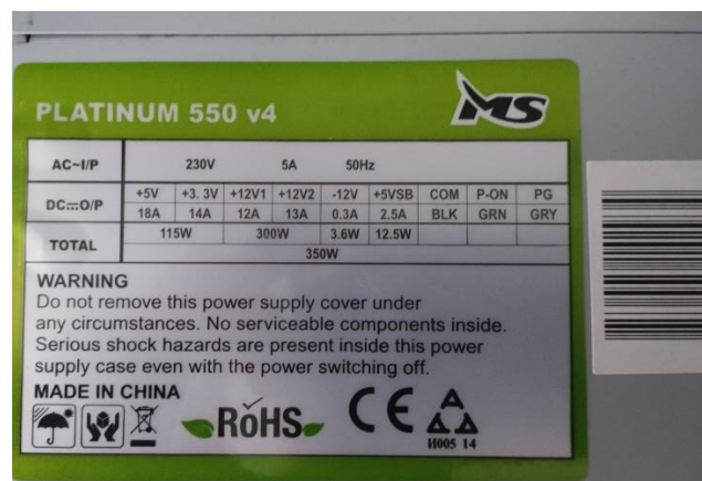
Slika 14. Predodžba tehničkih podataka PC napajanja. Izvor [Autor].
