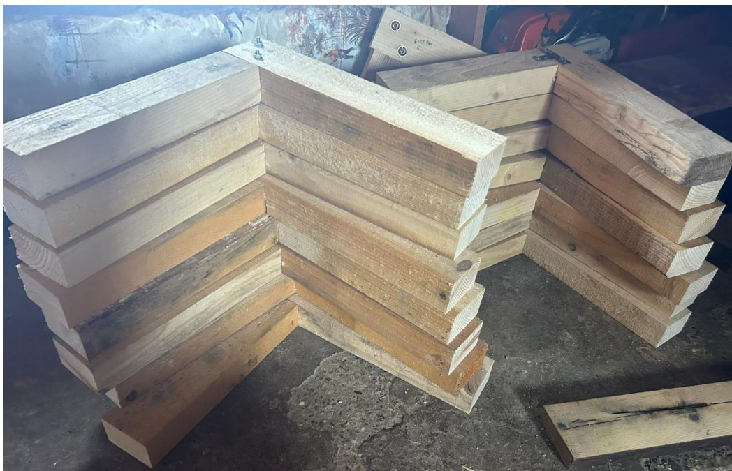
Slika 33. Uzorci za torzijsko ispitivanje
