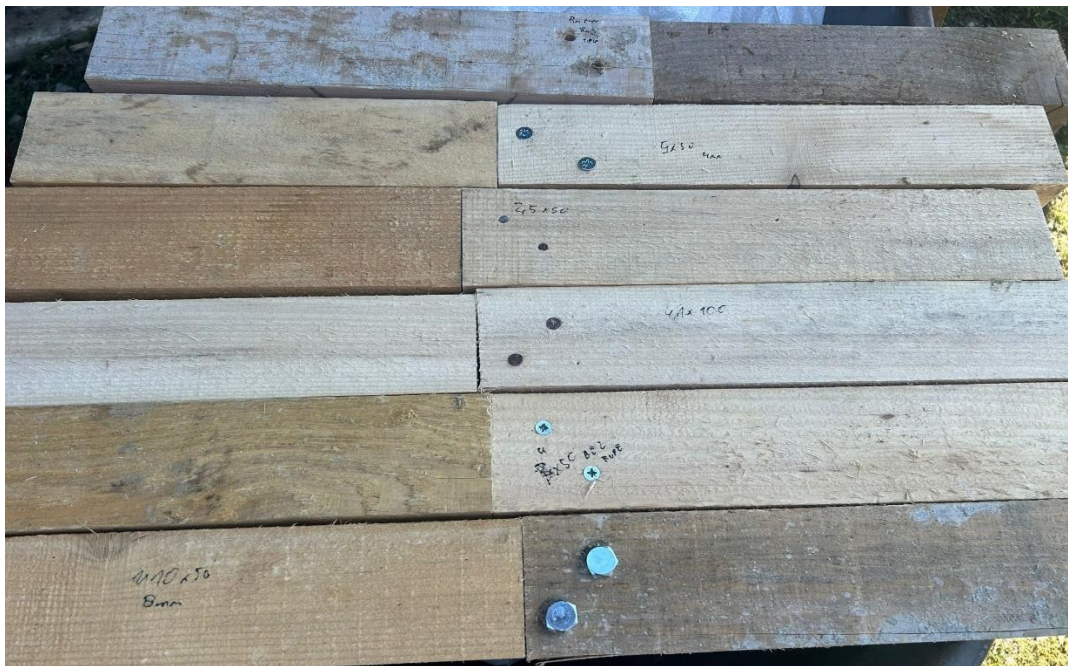
Slika 17. Uzorci za vlačno ispitivanje
