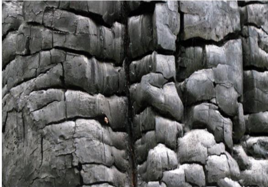
Slika 21. Karbonizirani komad drveta - "krokodilska koža" [26]
