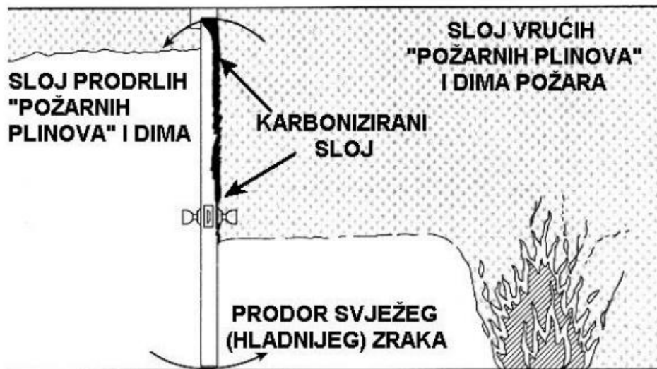
Slika 22. Pojava tragova karbonizacije iz smjera požara [24]
