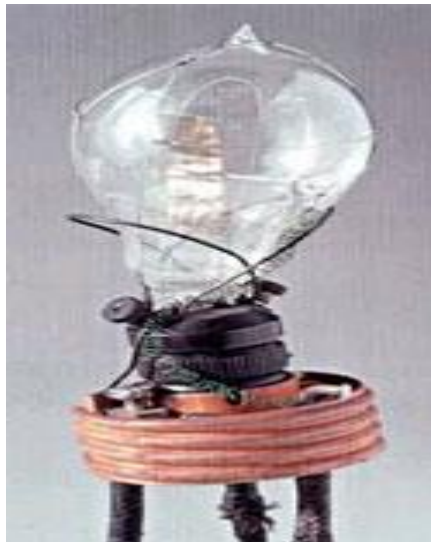
Slika 1. 'Ventil' ili vakuumska dioda Johna Fleminga koja dozvoljava tok struje u samo jednom smjeru (1904. godina) [2]
