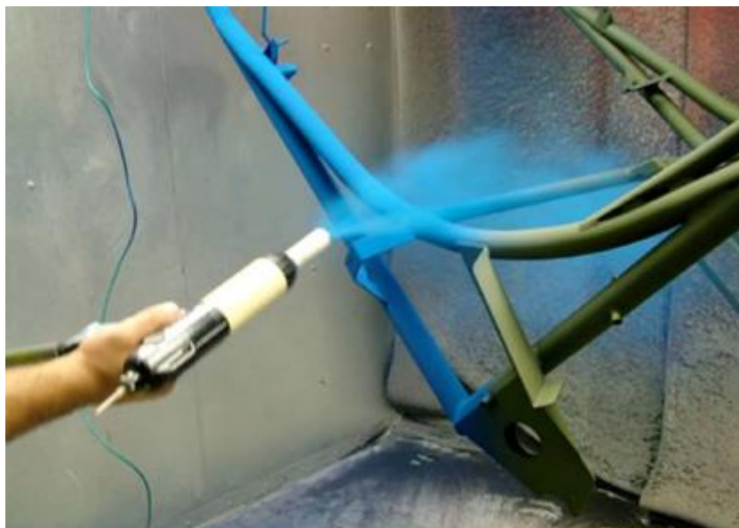
Slika 39. Plastifikacija aluminijskog profila. [25]
