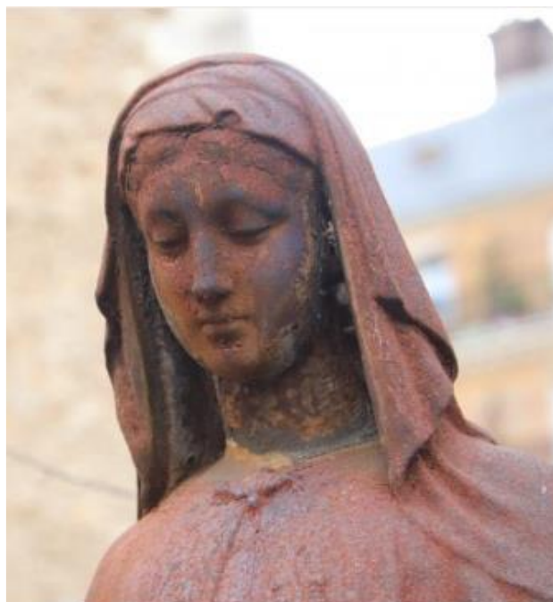
Slika 2. Utjecaj korozije na željeznu skulpturu. [4]
