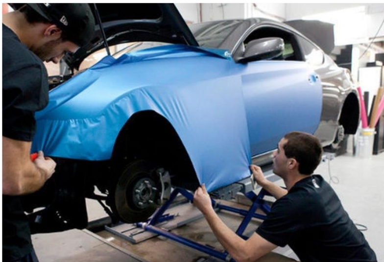
Slika 31. Vinilna folija na automobilu. [15]
