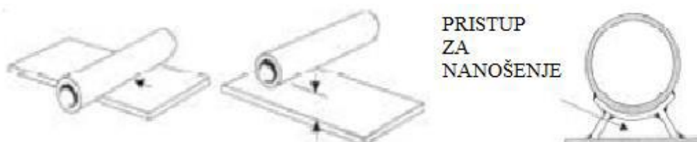
Slika 22. Izvedbe pravilnog postavljanja cjevovoda. [14]
