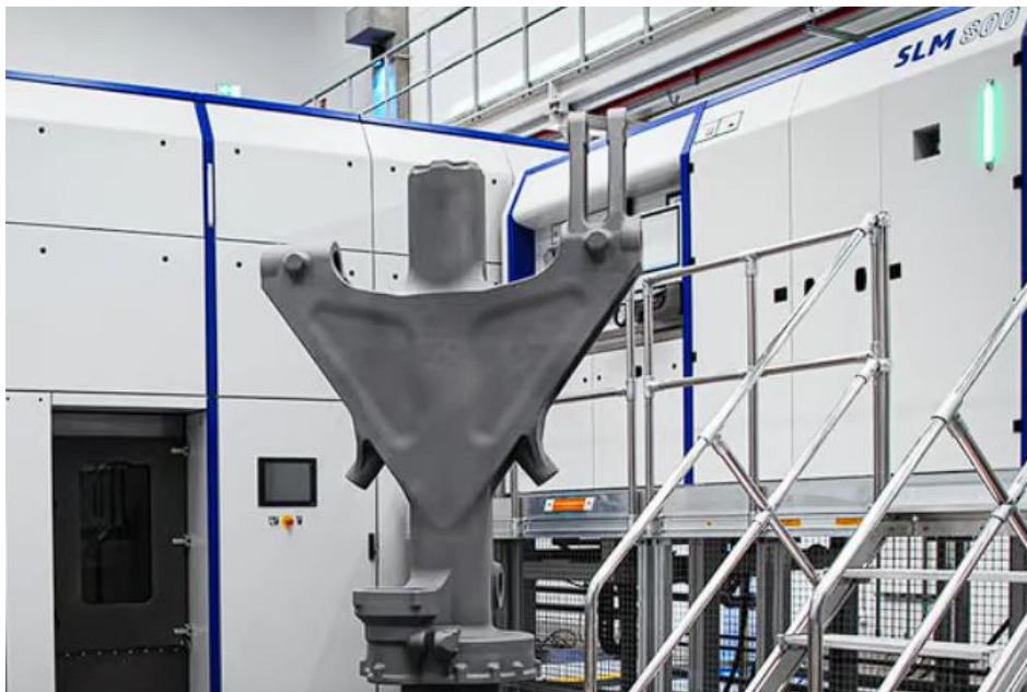
Slika 14 Stajni trap aviona izrađen SLM tehnologijom [11]
