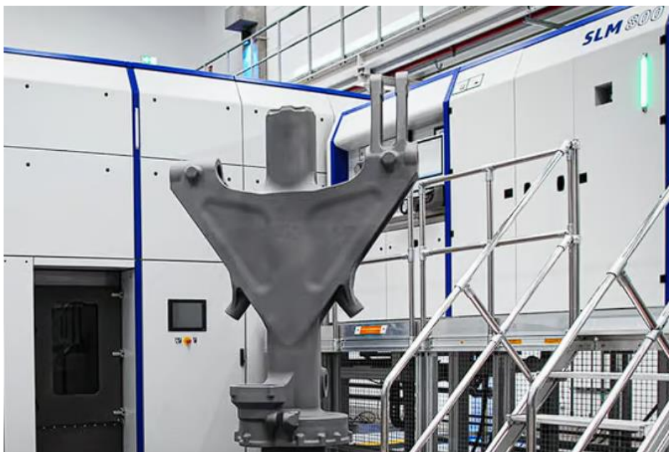
Slika 14 Stajni trap aviona izrađen SLM tehnologijom [11]
