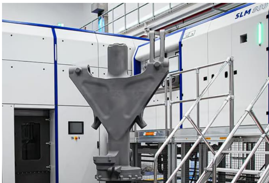
Slika 14 Stajni trap aviona izrađen SLM tehnologijom [11]
