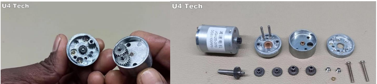
Slika 25. Predodžba dijelova unutar motora s reduktorom
