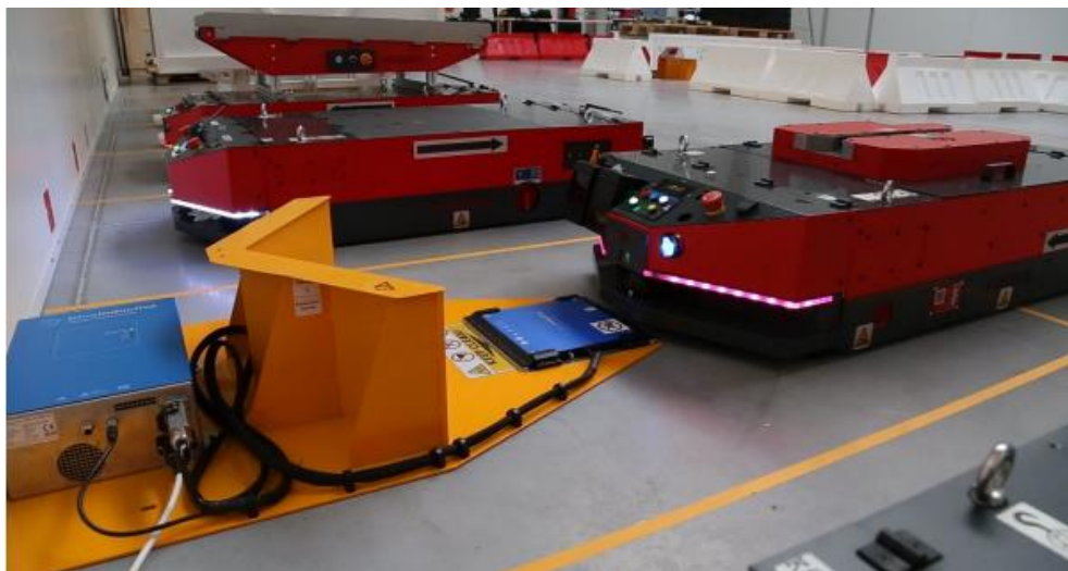
Slika 17. Predodžba stanice za beskontaktno punjenje AGV-a
