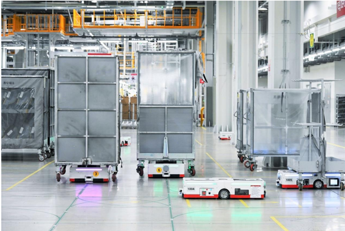
Slika 2. Automatizirano vođena vozila u proizvodnom centru LG Smart Park
