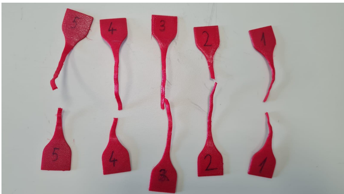
Slika 31. Epruvete od TPU 89A nakon provedenog ispitivanja
