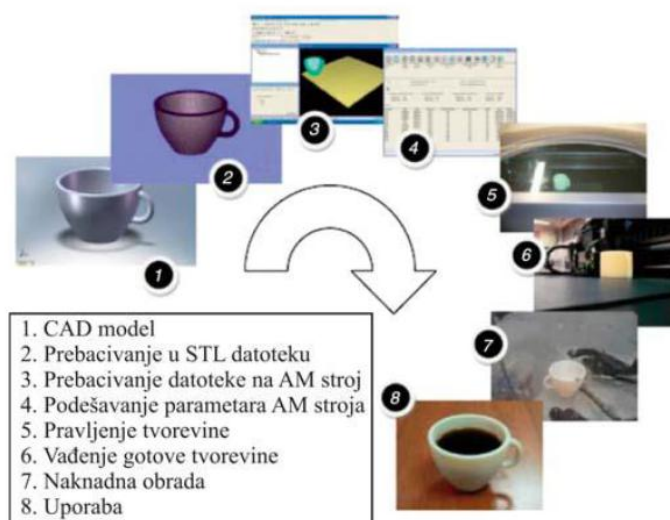
Slika 2. Faze proizvodnje aditivnom tehnologijom [4]
