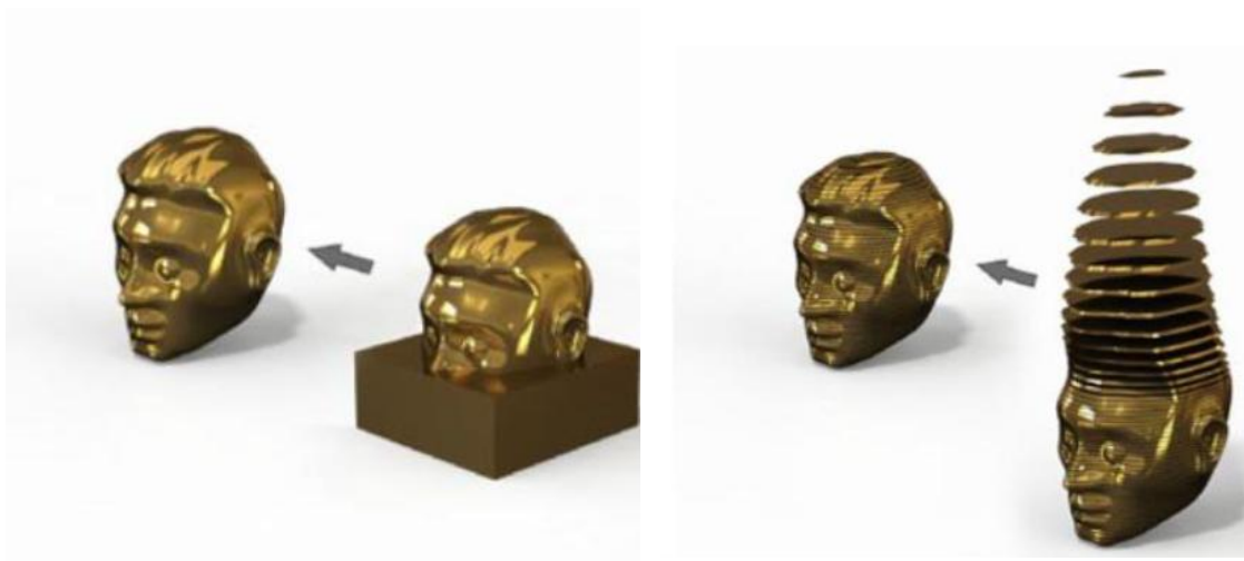
Slika 1. Usporedba izrade modela pomoću obrade odvajanjem čestica ( lijevo) i izrada predmeta aditivnim postupkom (desno) [1]
