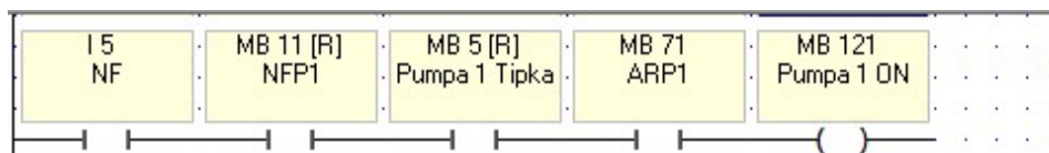
Slika 13. Predodžba I funkcije. Izvorno autor
