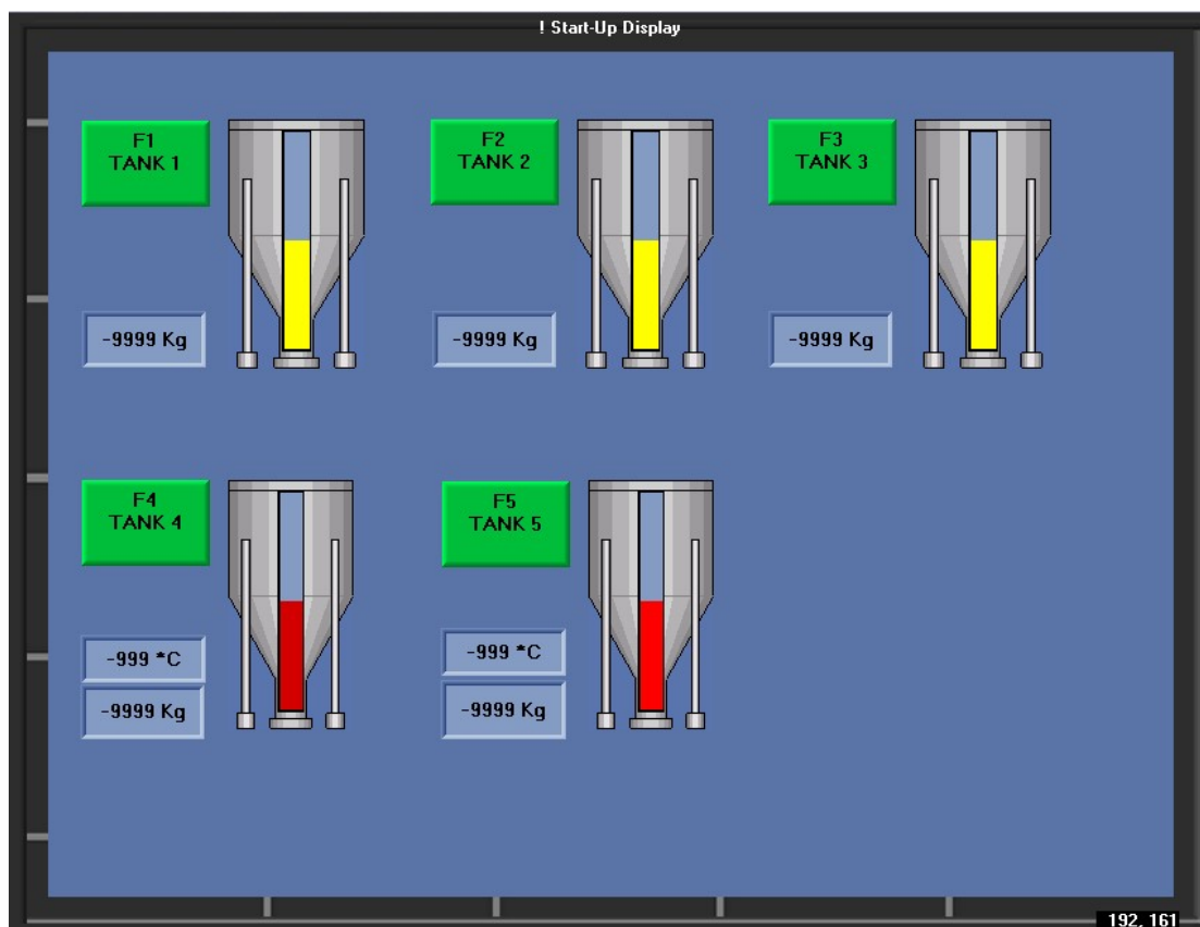
Slika 24. Predodžba početnog zaslona na PLC-u. Izvorno autor
