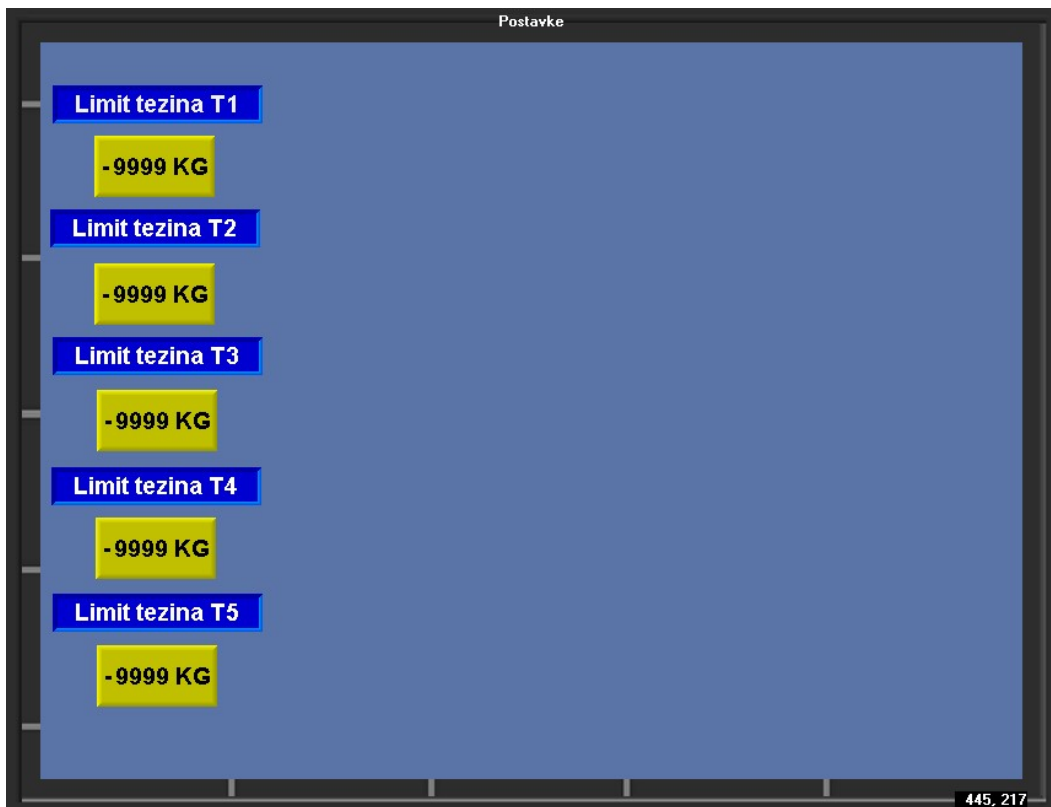
Slika 49. Predodžba postavljanja podataka o limita težina na zaslonu PLC-a. Izvorno autor.
