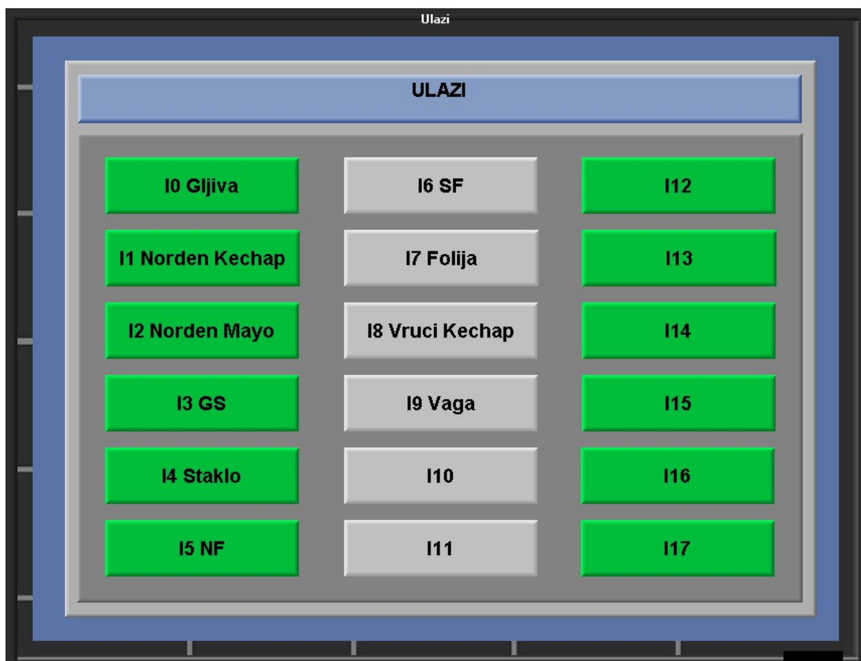
Slika 47. Predodžba aktivnih ulaza na PLC-u ili proširenju. Izvorno autor.
