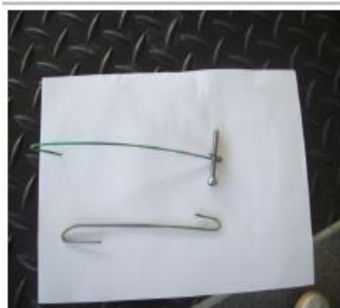
Slika 31. Držači proizvoda prilikom anodizacije [9]
