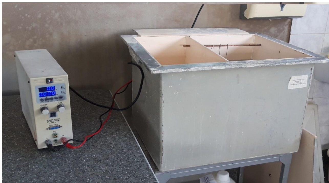
Slika 29. Ispravljač i kadica s elektrolitom [9]
