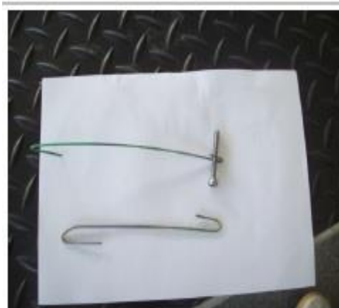
Slika 31. Držači proizvoda prilikom anodizacije [9]
