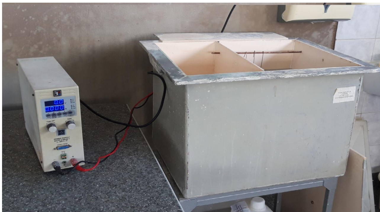
Slika 29. Ispravljač i kadica s elektrolitom [9]
