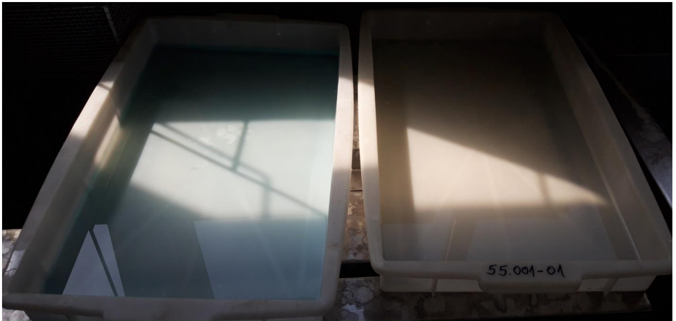
Slika 28. Smjesa kiselina za dekapiranje i vodovodna voda [9]
