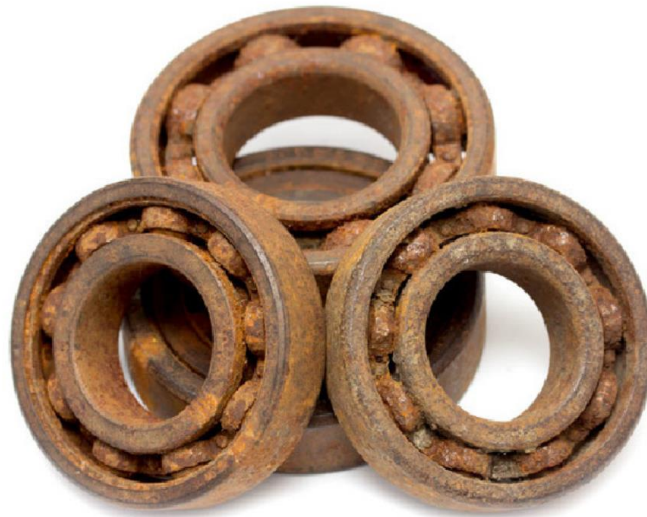
Slika 25. Primjer korodiranih ležajeva [10]
