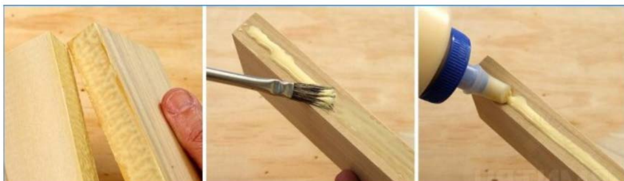
Slika 33. Nanošenje ljepila na drvo. [69]
