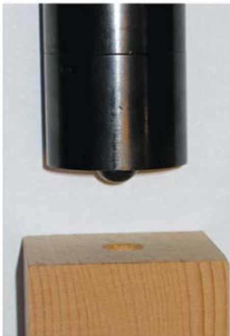
Slika 10. Postupak ispitivanja tvrdoće metodom Janka. [26]
