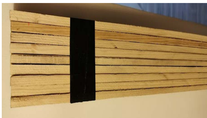
Slika 46. Izrezani uzorci dimenzija 1500x50x10 mm.
