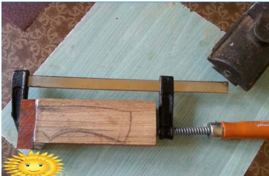
Slika 34. Stezanje lijepljenog spoja. [73]
