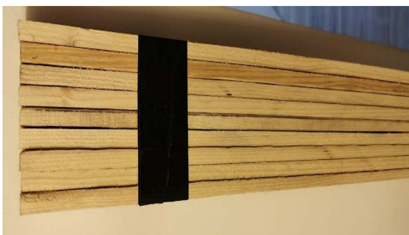
Slika 46. Izrezani uzorci dimenzija 1500x50x10 mm.
