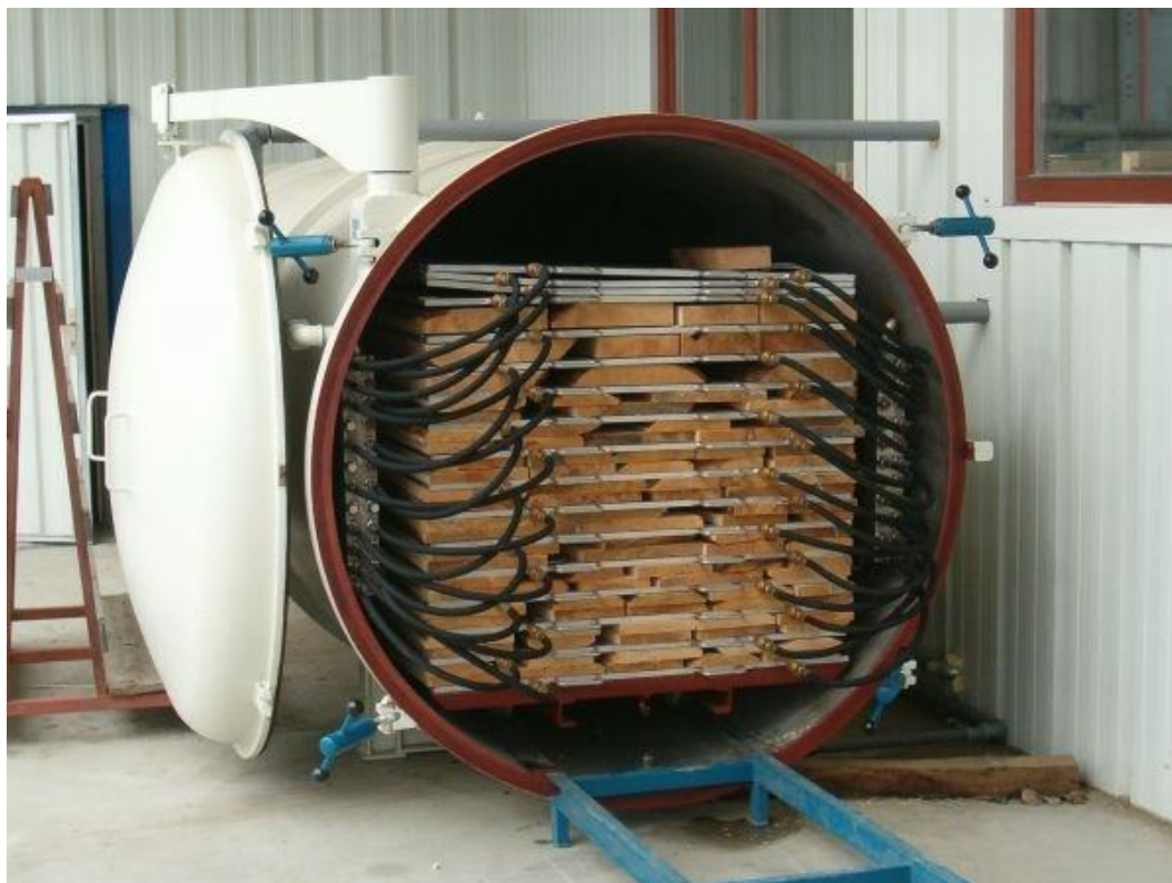
Slika 4. Vakumske sušare za drvo. [12]
