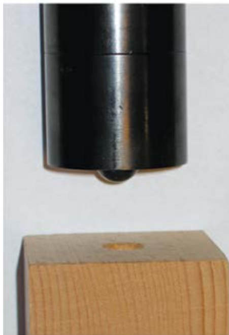
Slika 10. Postupak ispitivanja tvrdoće metodom Janka. [26]
