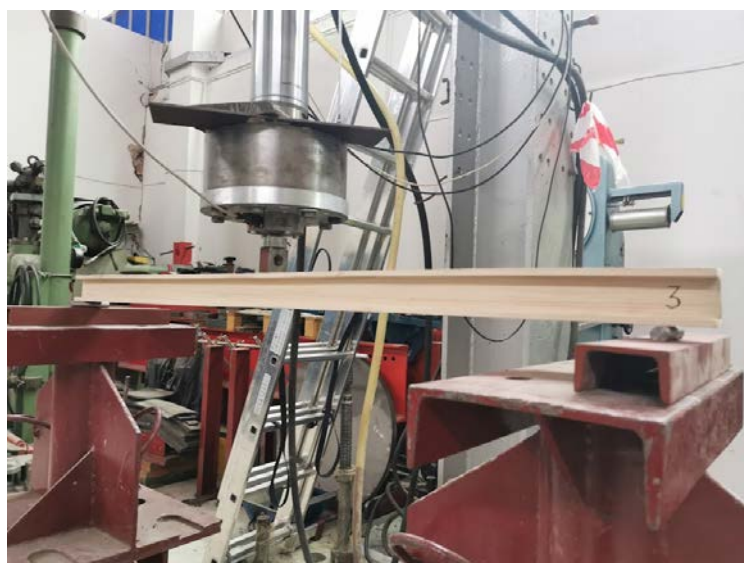
Slika 50. Priprema uzoraka za savojno ispitivanje.
