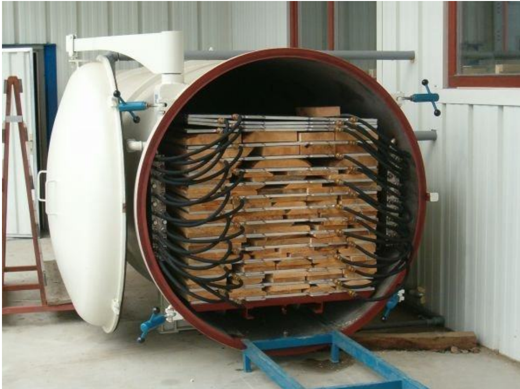
Slika 4. Vakumske sušare za drvo. [12]
