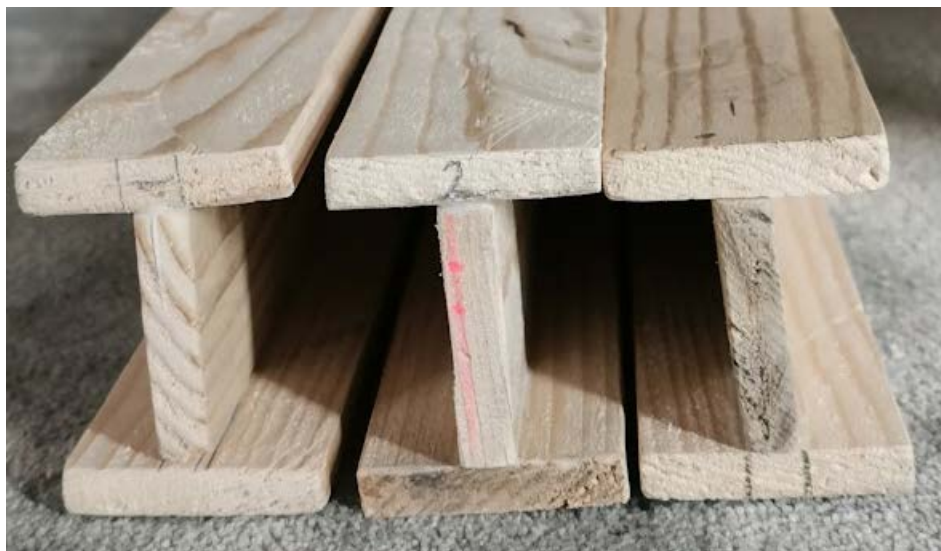
Slika 49. Drveni nosači "I" profila
