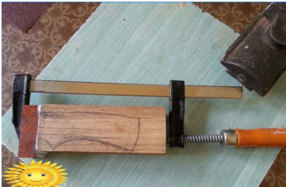
Slika 34. Stezanje ljepljenog spoja. [73]
