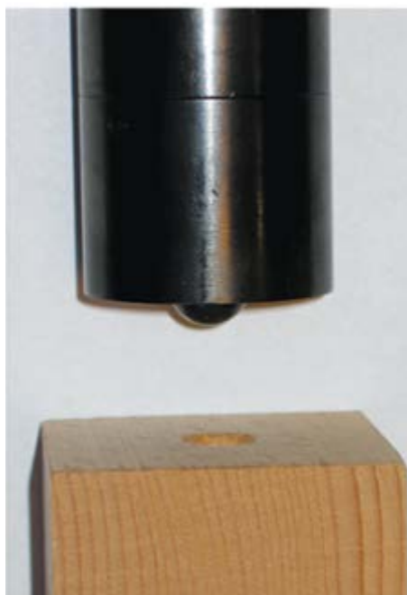
Slika 10. Postupak ispitivanja tvrdoće metodom Janka. [26]
