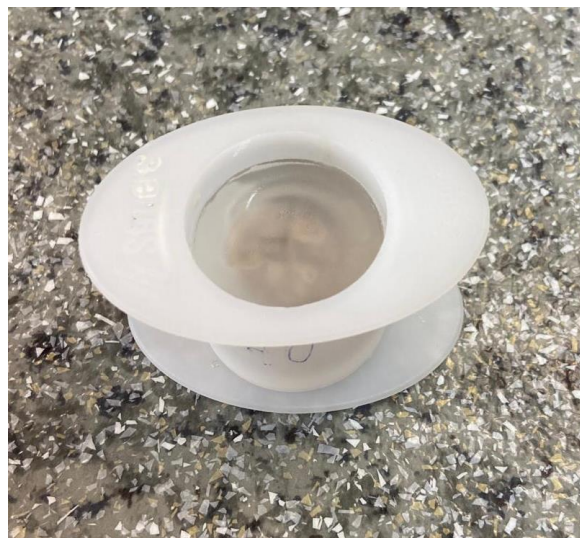
Slika 34. Uzorak zaliven smolom [18]
