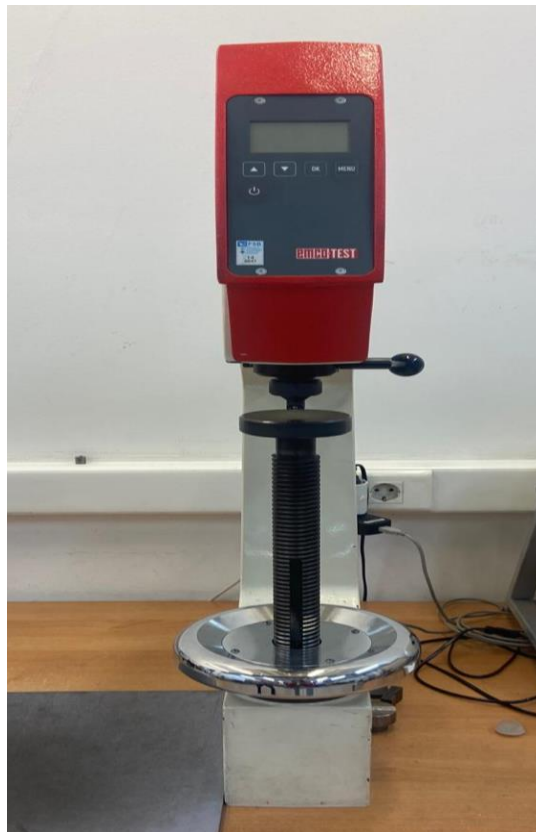
Slika 26. Uređaj za ispitivanje tvrdoće [18]
