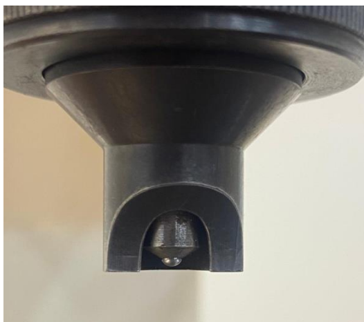
Slika 27. Penetrant u obliku kuglice – Brinell metoda [18]
