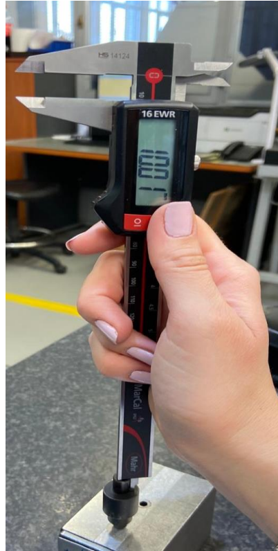
Slika 47. Mjerenje promjera obratka s pomičnim mjerilom [18] Slika 48. Mjerenje dužinske mjere obratka pomičnim mjerilom [18]
