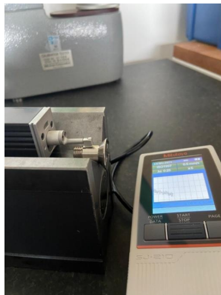
Slika 52. Ispitivanje hrapavosti na drugom obratku [18] Slika 53. Grafički prikaz tijekom mjerenja hrapavosti površine [18]
