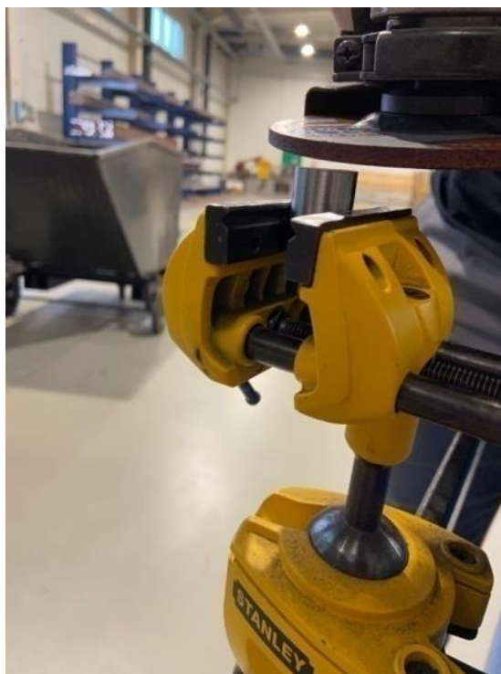
Slika 23. Priprema uzorka za ispitivanje kemijskog sastava [18]
