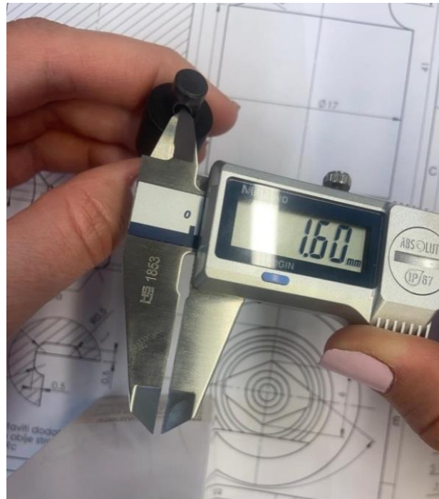
Slika 58. Mjerenje unutarnjeg promjera pomičnim mjerilom [18]
