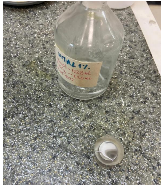
Slika 40. Nagrivanje uzorka Nitalom [18]
