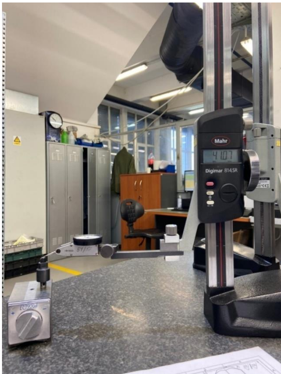
Slika 56. Mjerenje obratka na visinomjeru na završnoj kontroli [18] Slika 57. Prikaz ticala visinomjera na obratku [18]
