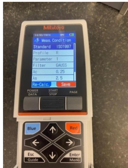
Slika 50. Mjerenje hrapavosti na prvom obratku [18] Slika 51. Prikaz parametara na uređaju za mjerenje hrapavosti [18]
