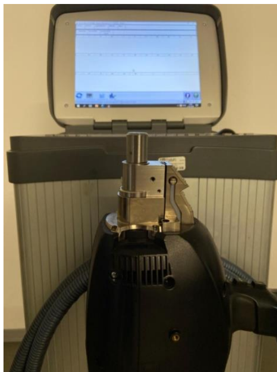
Slika 24. Ispitivanje kemijskog sastava na spektrometru [18]
