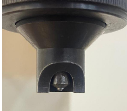
Slika 27. Penetrant u obliku kuglice – Brinell metoda [18]
