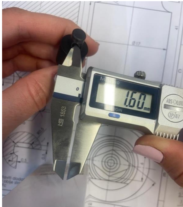
Slika 58. Mjerenje unutarnjeg promjera pomičnim mjerilom [18]
