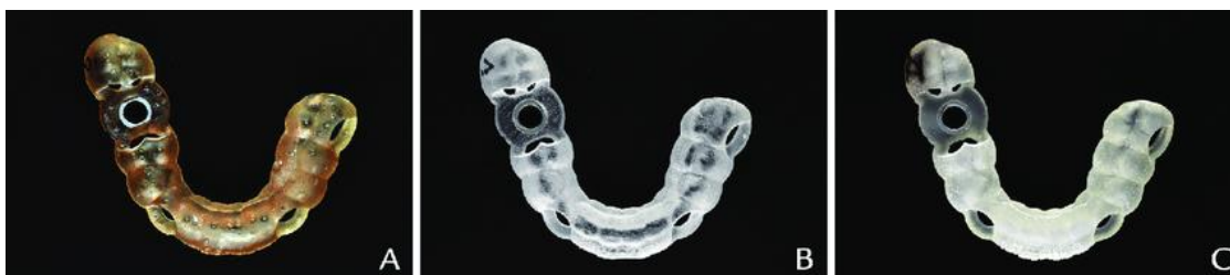
Slika 9. Aditivno proizvedene dentalne vodilice, A – Stereolitografija; B – PolyJet; C – Multijet [9]
