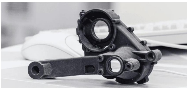
Slika 7. Dio isprintan Polyjet tehnologijom [6]
