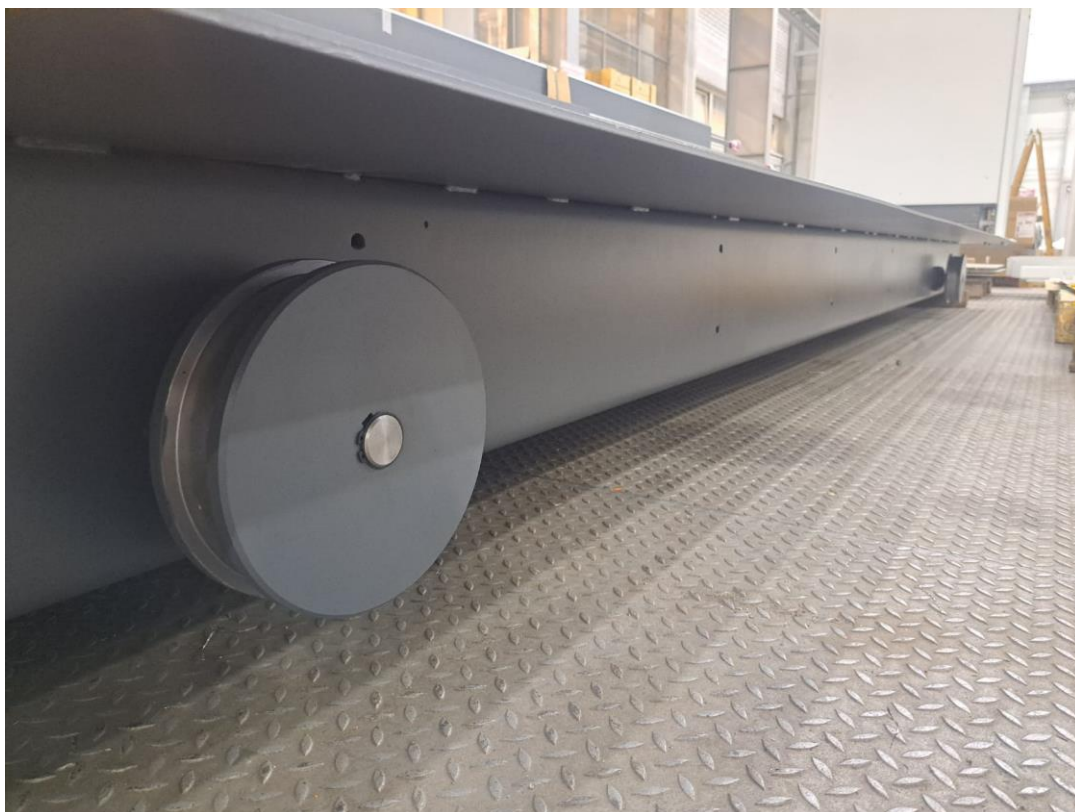
Slika 31. Pogonski kotači s vijencem na podvozju kolica
