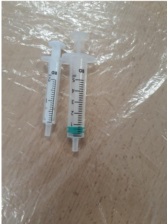
Slika 29. Šprice za uzimanje volumnog udjela komponenata
