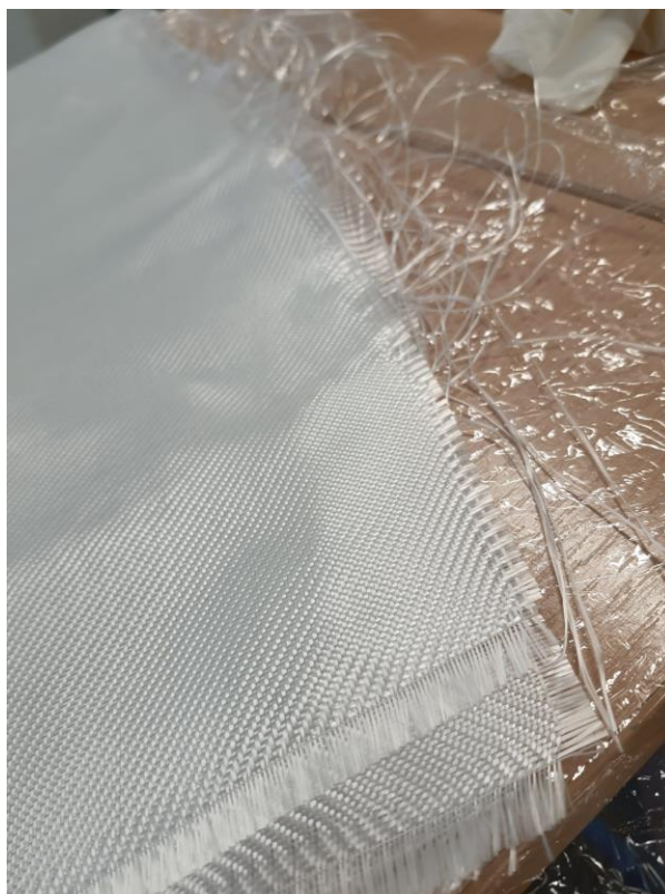
Slika 32. Staklena vlakna orijentirana pod pravim kutom
