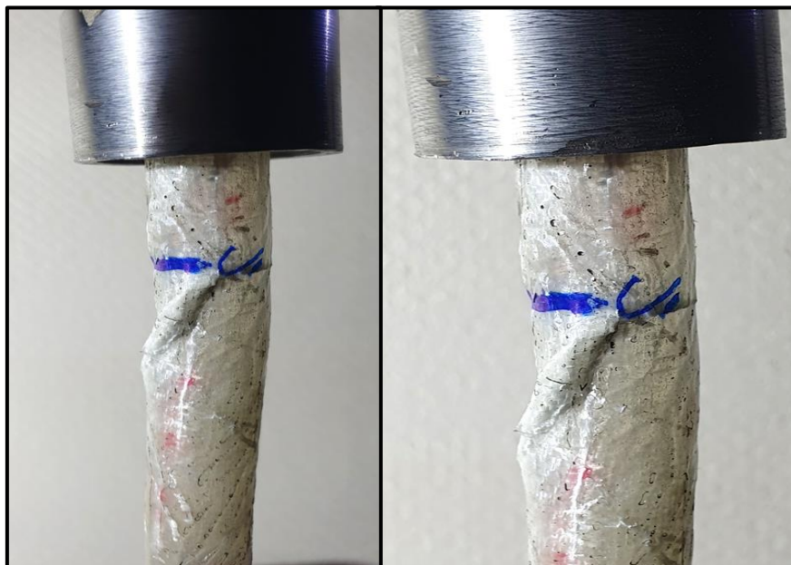
Slika 46. Oštećenje uzorka 0/90° nakon uvijanja
