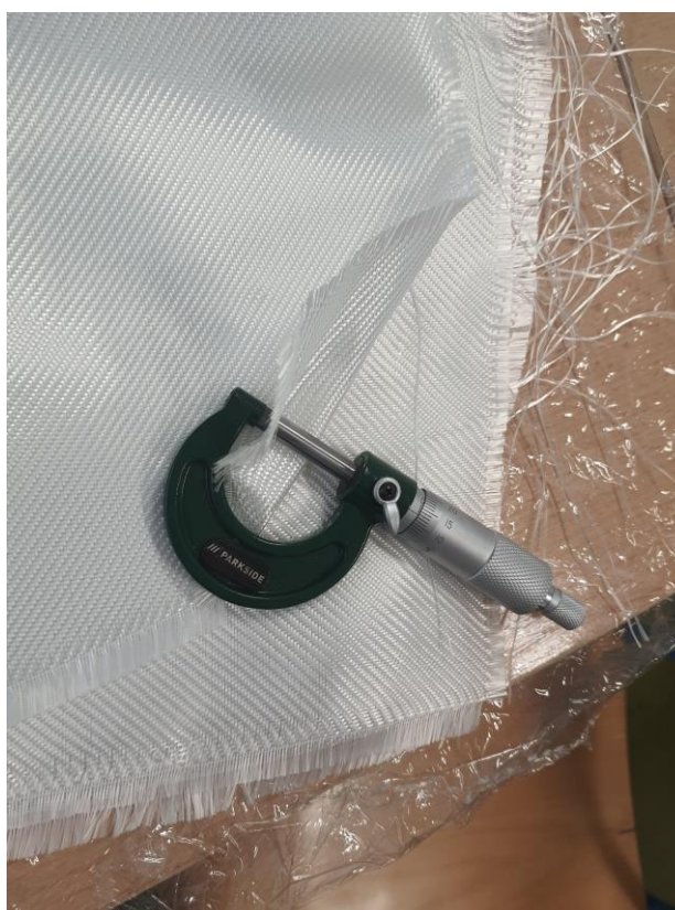
Slika 33. Mjerenje debljine tkanine mikrometrom
