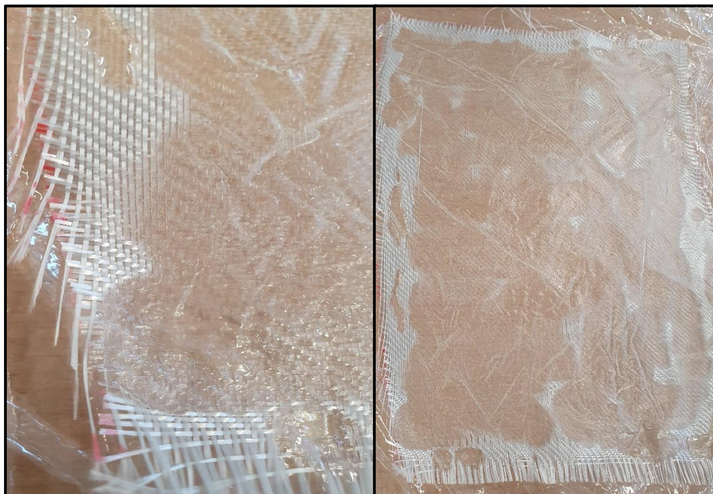
Slika 36. Tkanina namočena epoksidnom smolom
