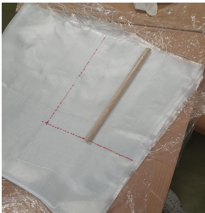
Slika 35. Priprema tkanine za rezanje
