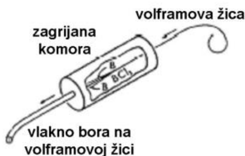
Slika 13. Proizvodnja bornih vlakana [9]
