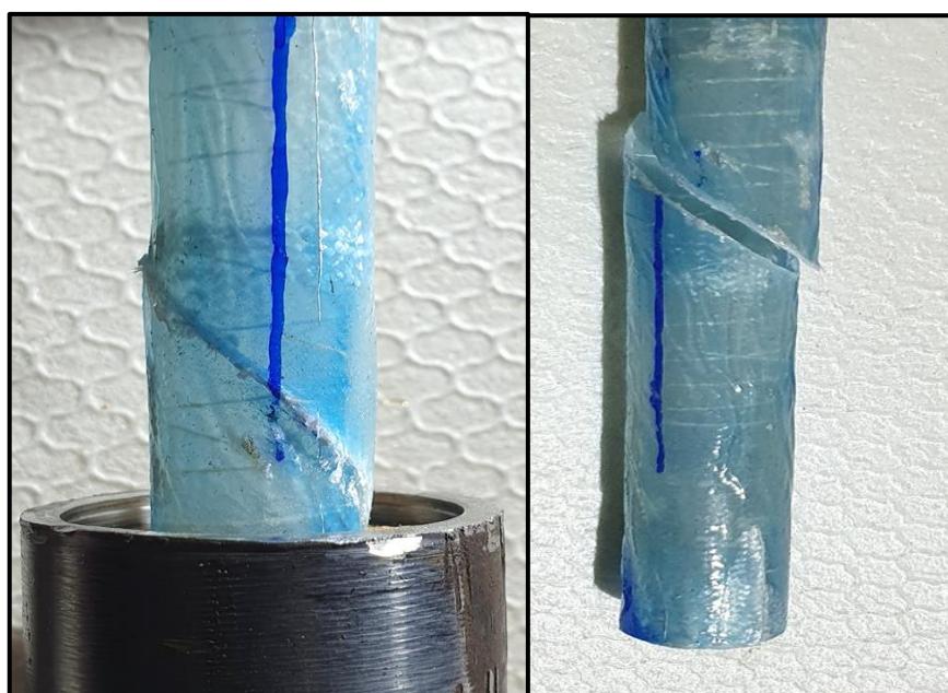
Slika 47. Oštećenje uzorka \pm 45^\circ nakon uvijanja
