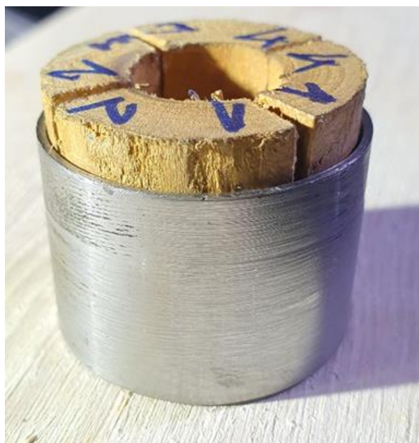
Slika 42. Stezna konusna čahura
