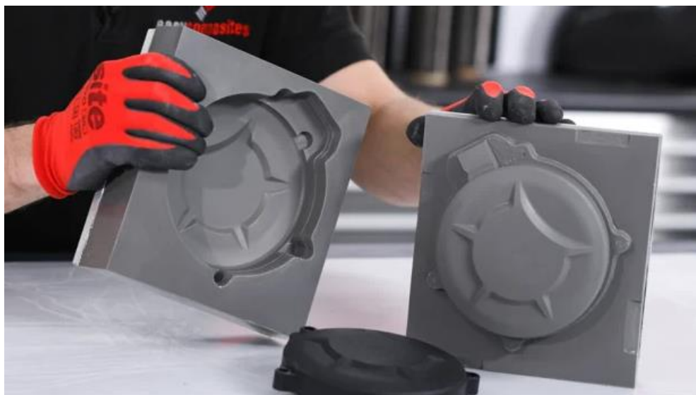
Slika 23. Dvodijelni kalup za izradu kompozita [18]
