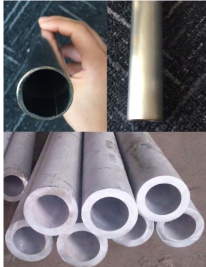
Slika 6: Usporedba bešavnih i šavnih cijevi[6]
