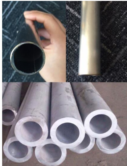
Slika 6: Usporedba bešavnih i šavnih cijevi[6]
