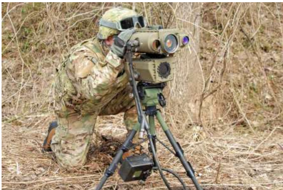
Slika 22., AN/PED-1 lagani daljinomjer s oznakom cilja, rad na principu lasera
