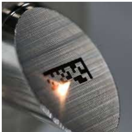
Slika 13., Lasersko označavanje komada metala QR kodom
