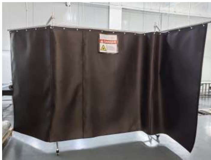
Slika 9., Zavjesa za zaštitu od laserskog zračenja pri postupku laserskog zavarivanja
