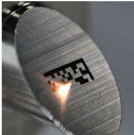
Slika 13., Lasersko označavanje komada metala QR kodom
