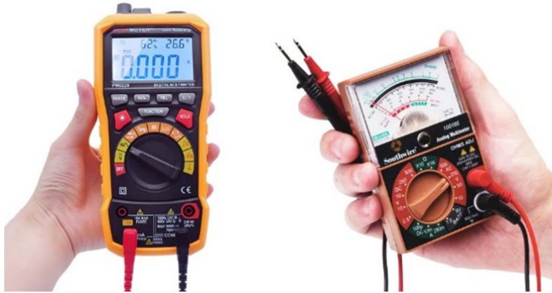
Slika 13. Digitalni i analogni multimetar [13]
