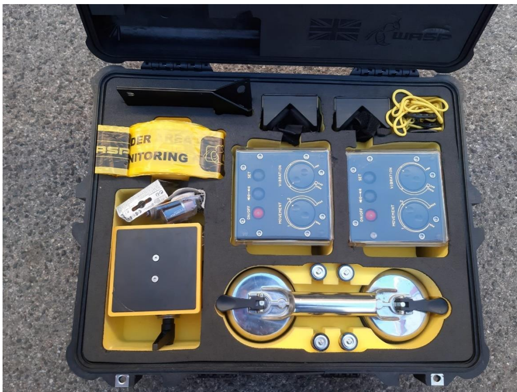
Slika 22. Uređaj za kontrolu stabilnosti građevine[10]
