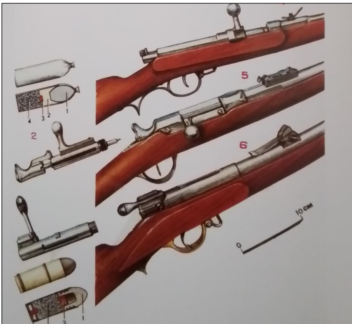
Sl. 3. Različite vrste zatvarača i pripadajućih naboja iz 19.stoljeća [2]
