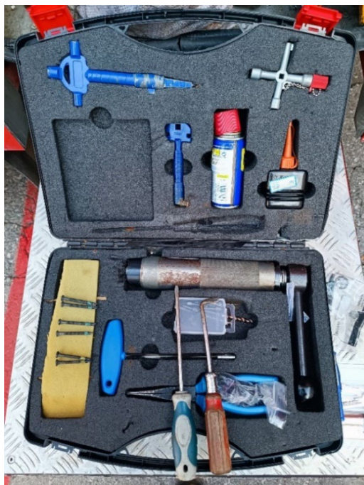
Slika 27. Alat za otvaranje vrata na objektu [6]
