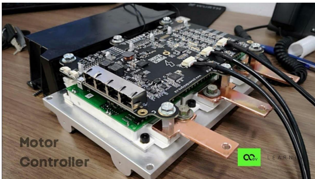
Slika 4. Kontroler sustava napajanja električnog vozila [6]
