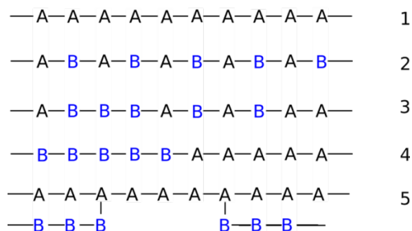
Slika 4. Shematski prikaz povezivanja monomernih jedinica. Označeni brojevima: 1 – homopolimer, 2 – alternirajući kopolimer, 3 – periodički kopolimer, 4 – statistički kopolimer, 5 – blok kopolimer i 6 – razgranati kopolimer.
