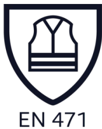
Slika 41. Piktogram i etiketa za zaštitnu odjeću visoke vidljivosti.
