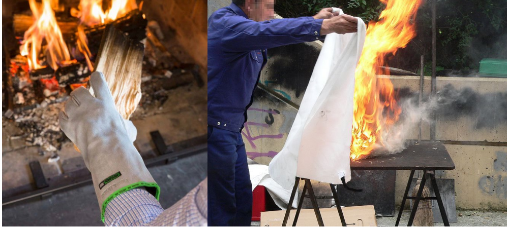
Slika 28. Uporaba kevlara u izradi osobne zaštite od vatre.
