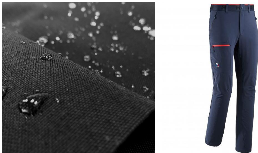
Slika 37. Hidrofobno svojstvo vodonepropusnih tkanina i primjer zaštitne odjeće (hlače) izrađene od vodootpornih materijala.
