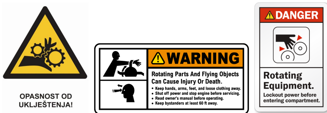
Slika 12. Opasnost od uklještenja - rotirajući predmeti uvlače zahvaćen dio tijela ili predmet (shematski prikaz i odgovarajući piktogrami)
