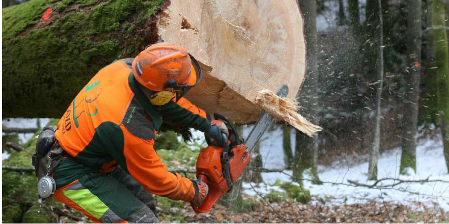
Slika 14. Radnik sa motornom pilom i zaštitnom opremom (kaciga sa vizirom, antifoni i zaštitna odjeća i obuća)
