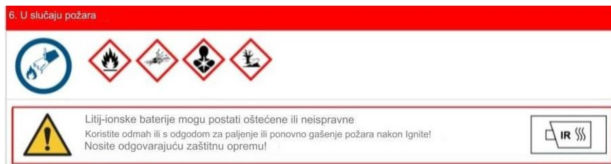
Slika 36. Postupak u slučaju požara [8]
