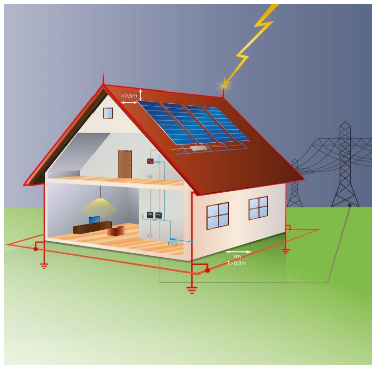
Slika 22. Princip zaštite od munje-groma na kući [9]
