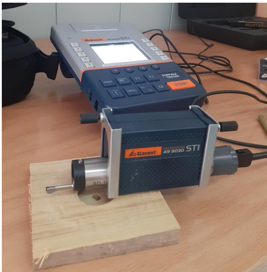
Slika 5 Garant ST1 Pertometar [izvorno autor]
