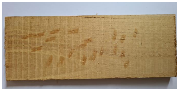
Slika 41 Uzorak bagrema nakon ispitivanja pomoću Brinellove metode [izvorno autor]
