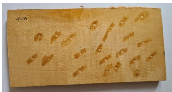
Slika 42 Uzorak johe nakon ispitivanja pomoću Brinellove metode [izvorno autor]
