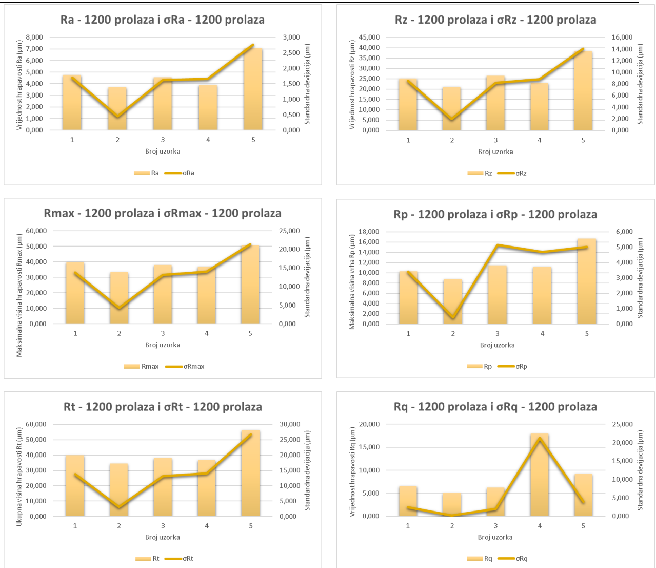
Slika 16 R_a , R_z , R_{max} , R_p , R_t i R_q joha nakon 1200 prolaza [izvorno autor]
