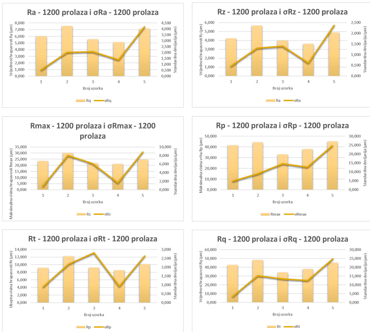
Slika 19 R_a , R_z , R_{max} , R_p , R_t i R_q oraha nakon 1200 prolaza [izvorno autor]
