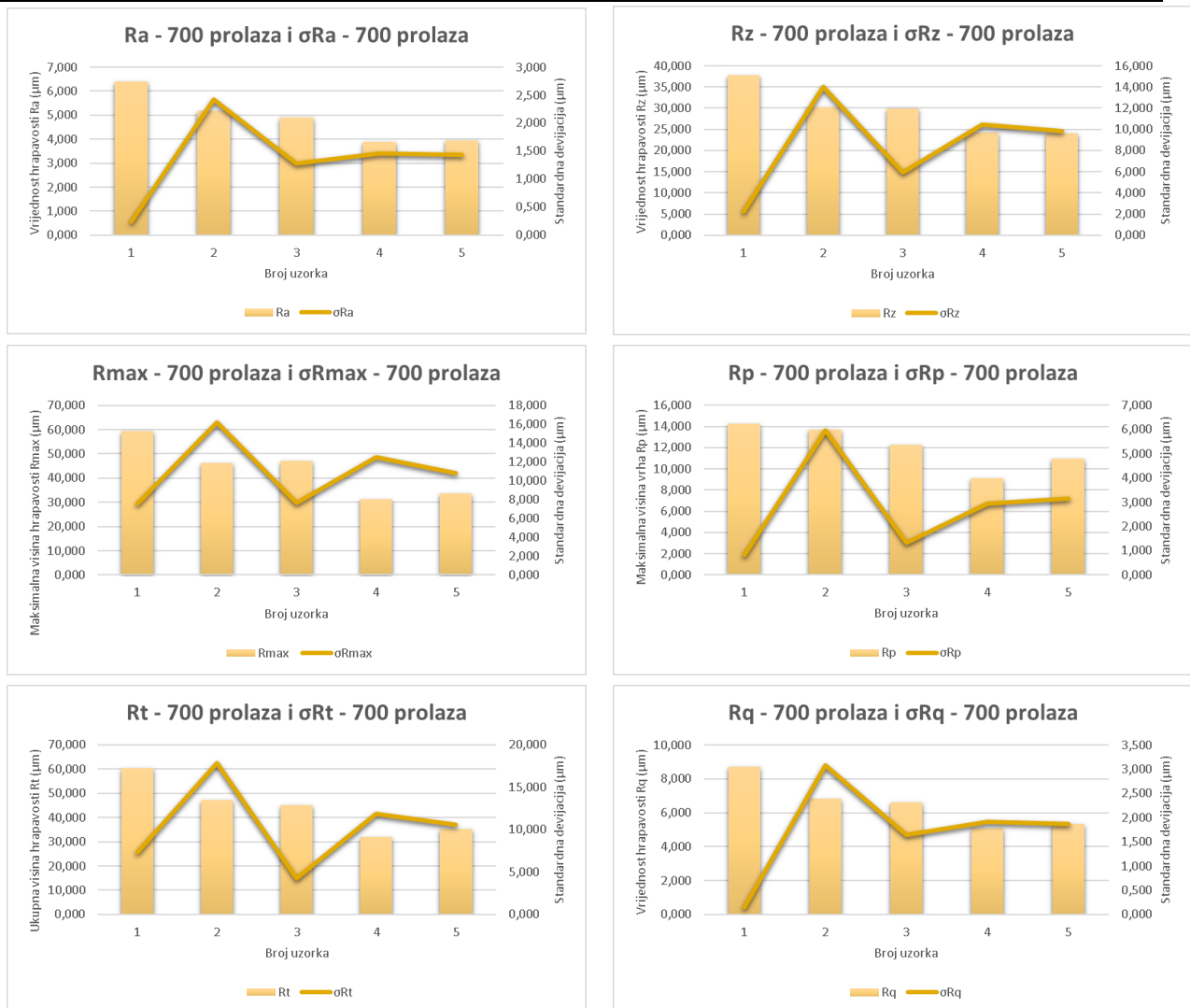
Slika 21 R_a , R_z , R_{max} , R_p , R_t i R_q topole nakon 700 prolaza [izvorno autor]
