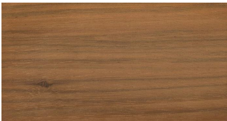
Slika 3 Tekstura obrađenog drva - orah [1]
