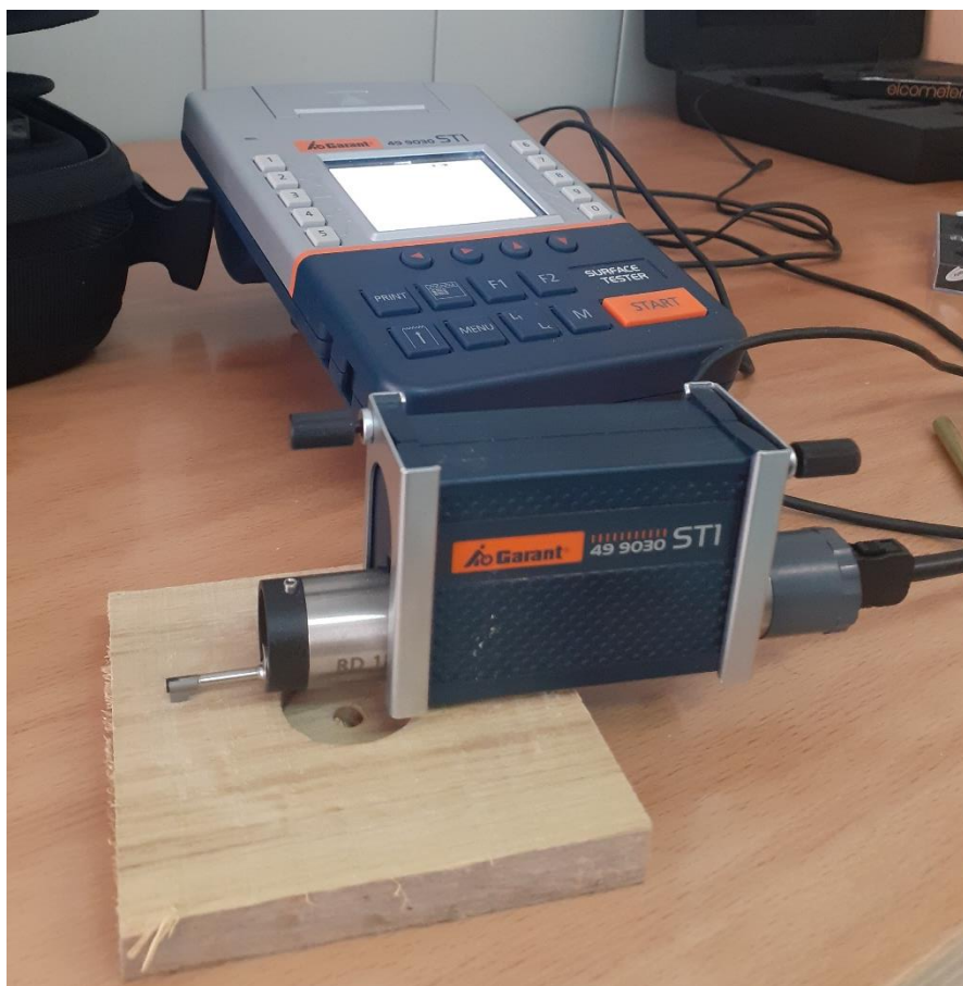
Slika 5 Garant ST1 Pertometar [izvorno autor]
