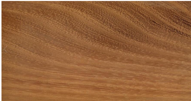
Slika 1 Tekstura obrađenog drva - bagrem [1]
