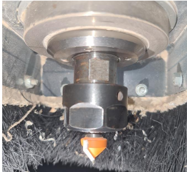
Slika 24 V- glodalo za graviranje [izvorno autor]
