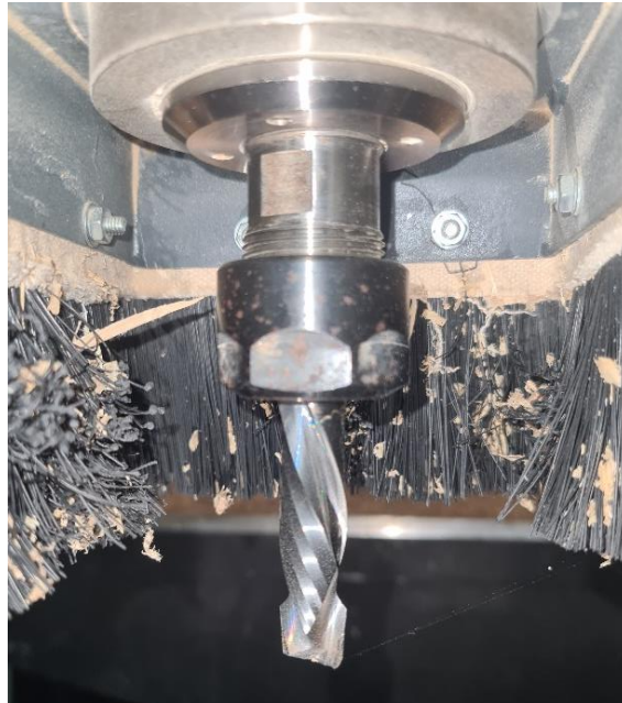
Slika 23 Glodalo za izradu kontura te udubina [izvorno autor]
