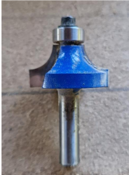
Slika 25 Profilno glodalo [izvorno autor]
