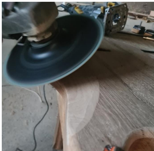
Slika 29 Ručna obrada teško obradivih područja tijela [izvorno autor]
