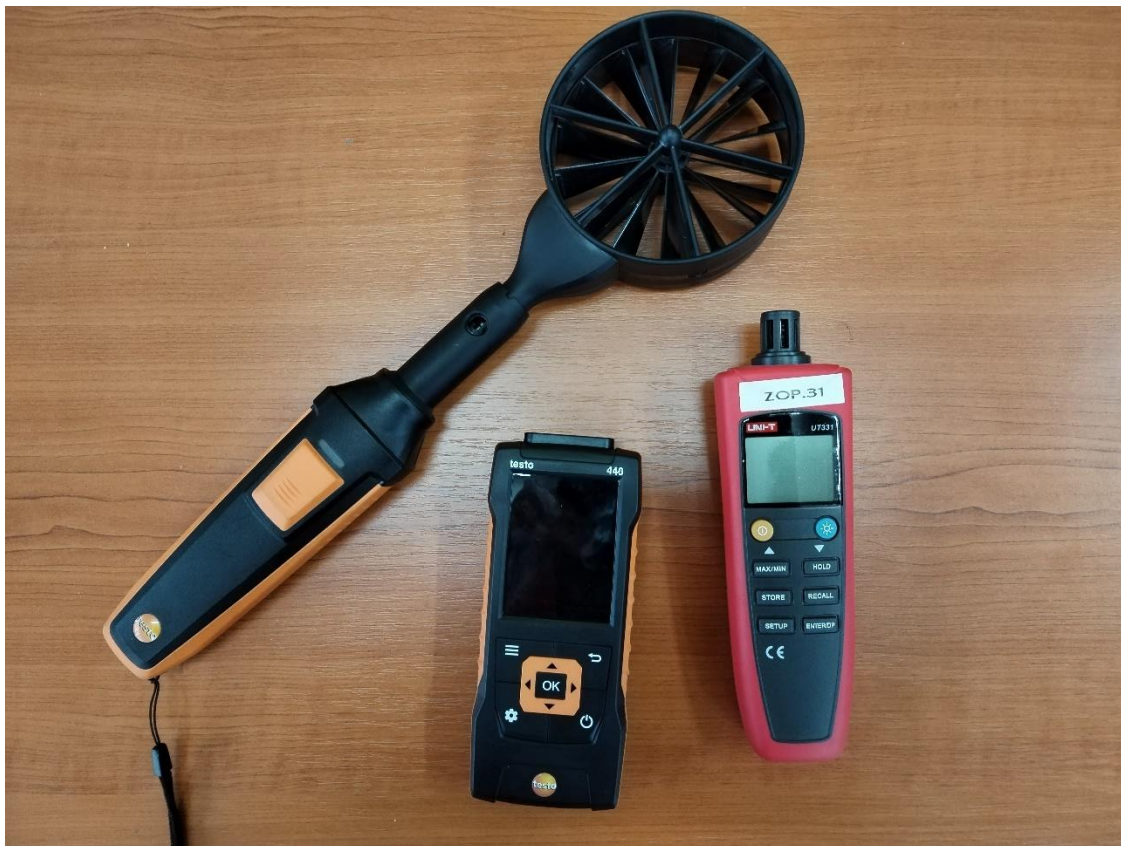
Slika 5. Anemometar TESTO i termohigrometar UNI-T korišteni za ispitivanje mikroklimatskih parametara radnog okoliša
