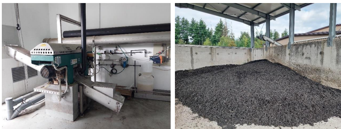
Slika 13: a) Centrifuga za mulj; b) Dehidrirani mulj na platou (autorske slike)
