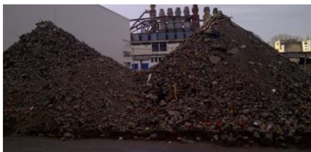
Slika 8. Materijal s nečistoćama dobiven nakon drobljenja [12]
