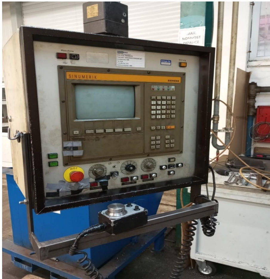
Slika 14. Numeričko upravljanje CNC tokarilice
