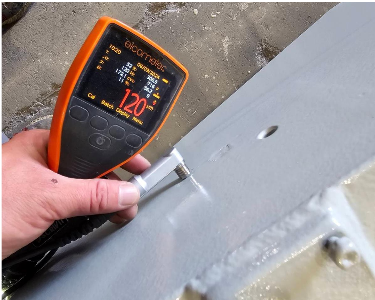
Slika 32. Mjerenje debljine boje Elcometrom
