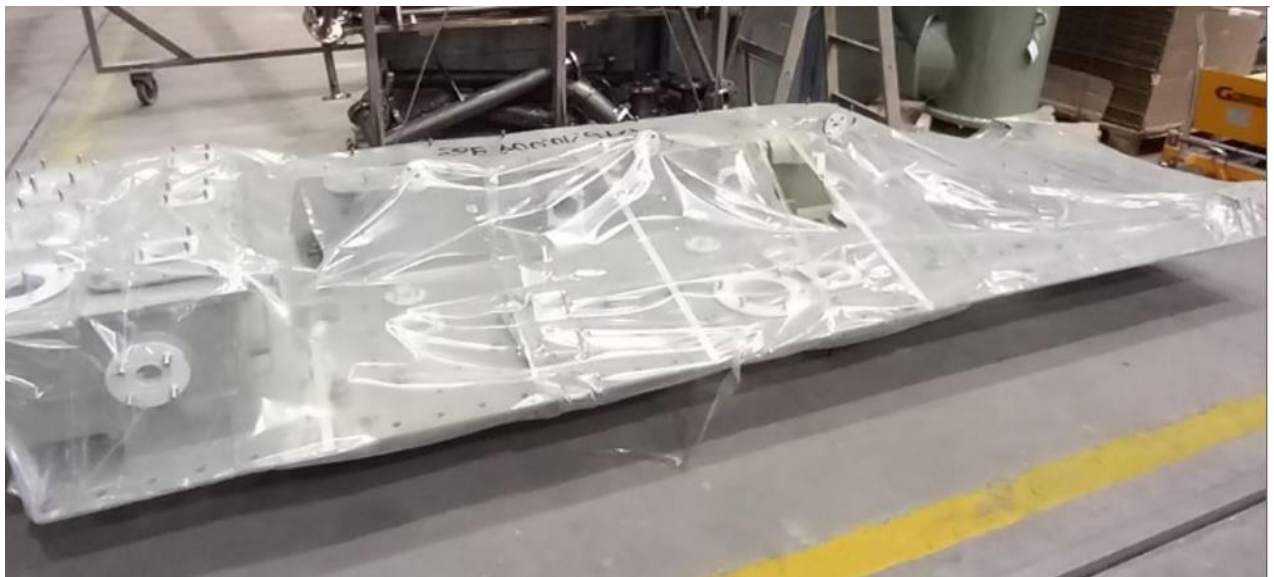
Slika 35. Zapakirani poklopac transformatora prije isporuke
