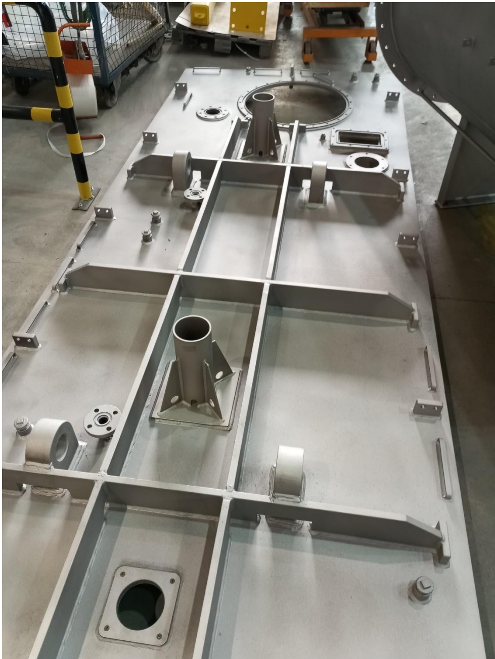
Slika 3. Poklopac transformatorskog kotla
