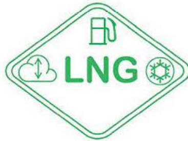
Slika 31. Oznaka vozila na ukapljeni prirodni plin sukladno normi ISO 17840 [15]
