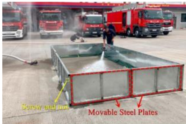
Slika 20. Modularne metalne barijere [10]
