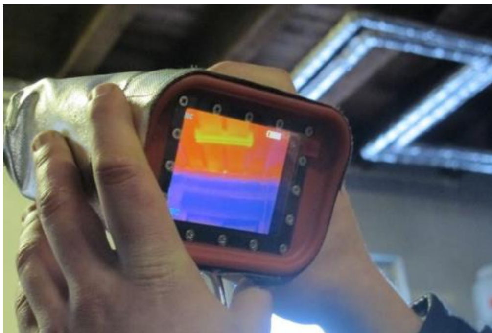
Slika 34. Provjera stupnja zagrijanosti baterije uporabom termovizijske kamere [17]
