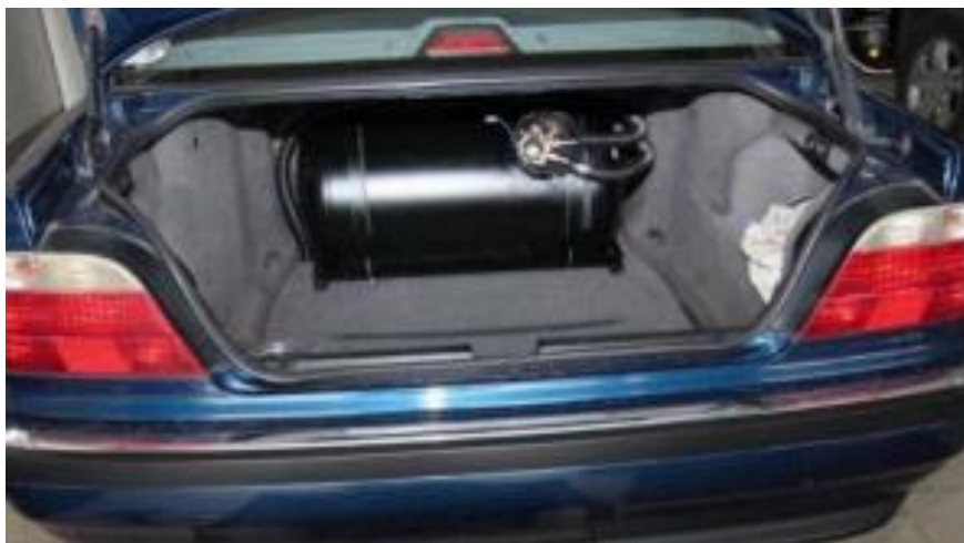
Slika 29. Spremnik prirodnog plina smješten u prtljažni prostor vozila [8]
