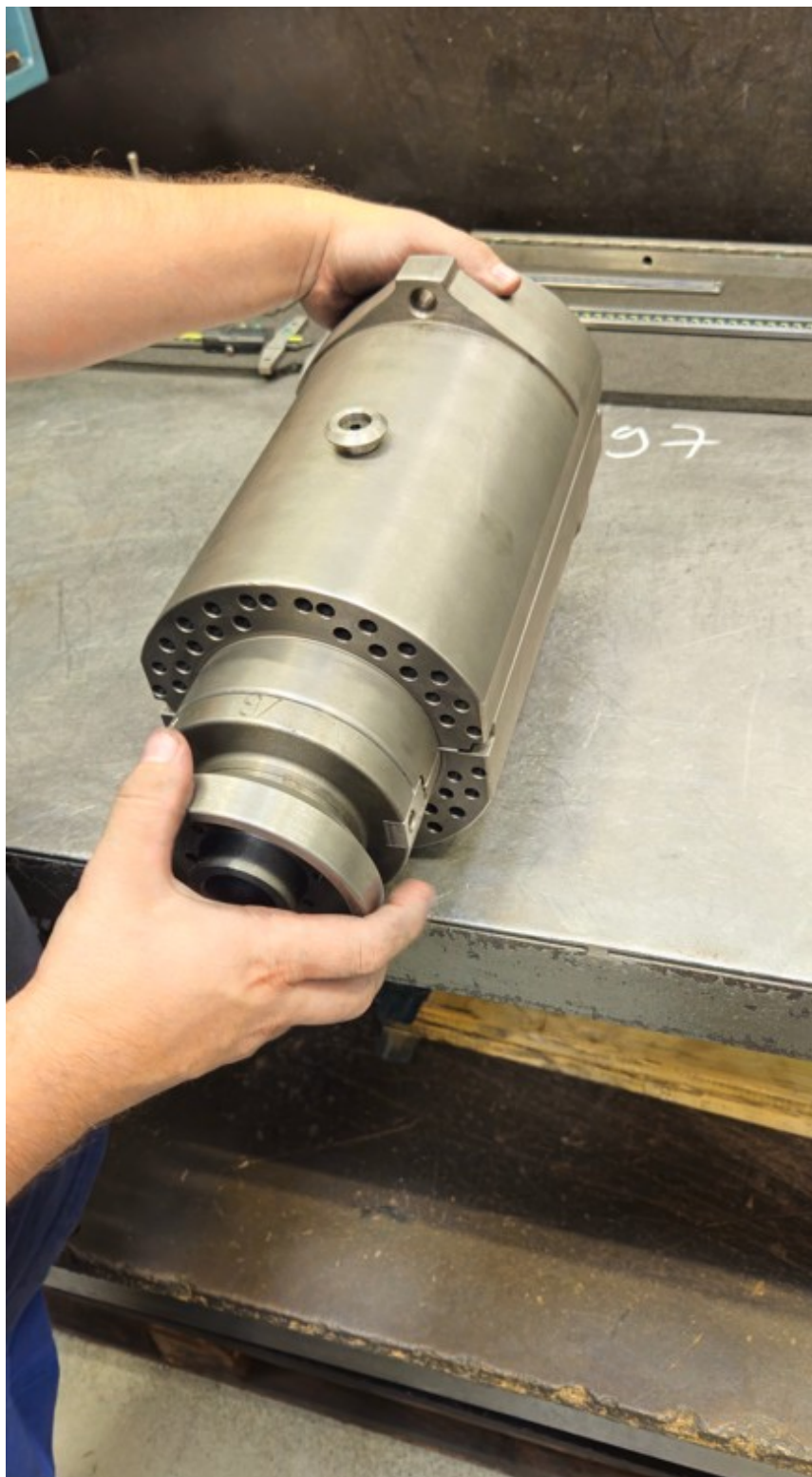
Slika 106. Provjera zračnosti cijelog sklopa
