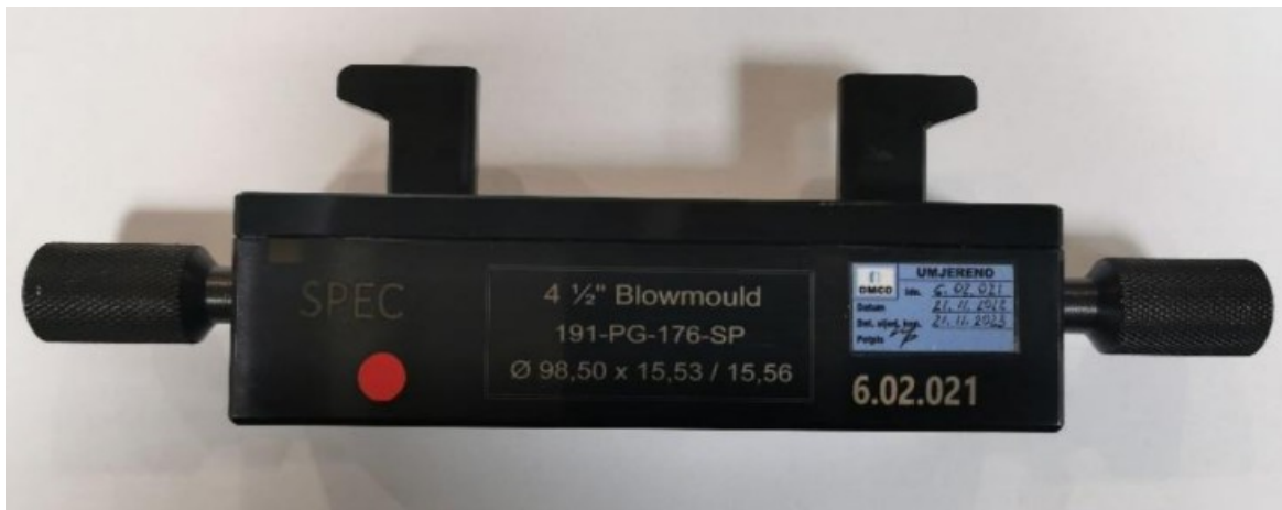
Slika 45. Kalibar za mjerenje visine prizme [15]
