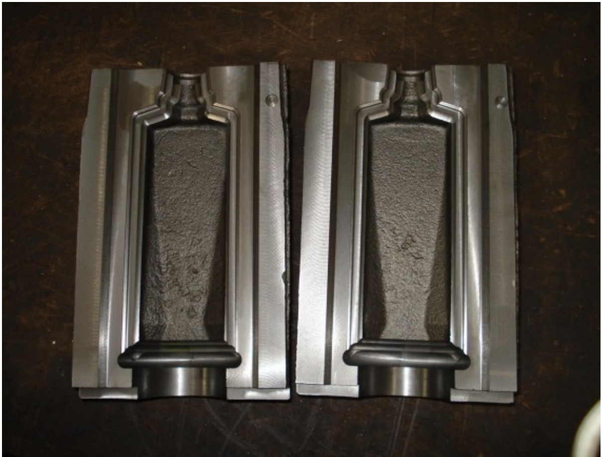
Slika 24. Glodanje prije metalizacije [11]
