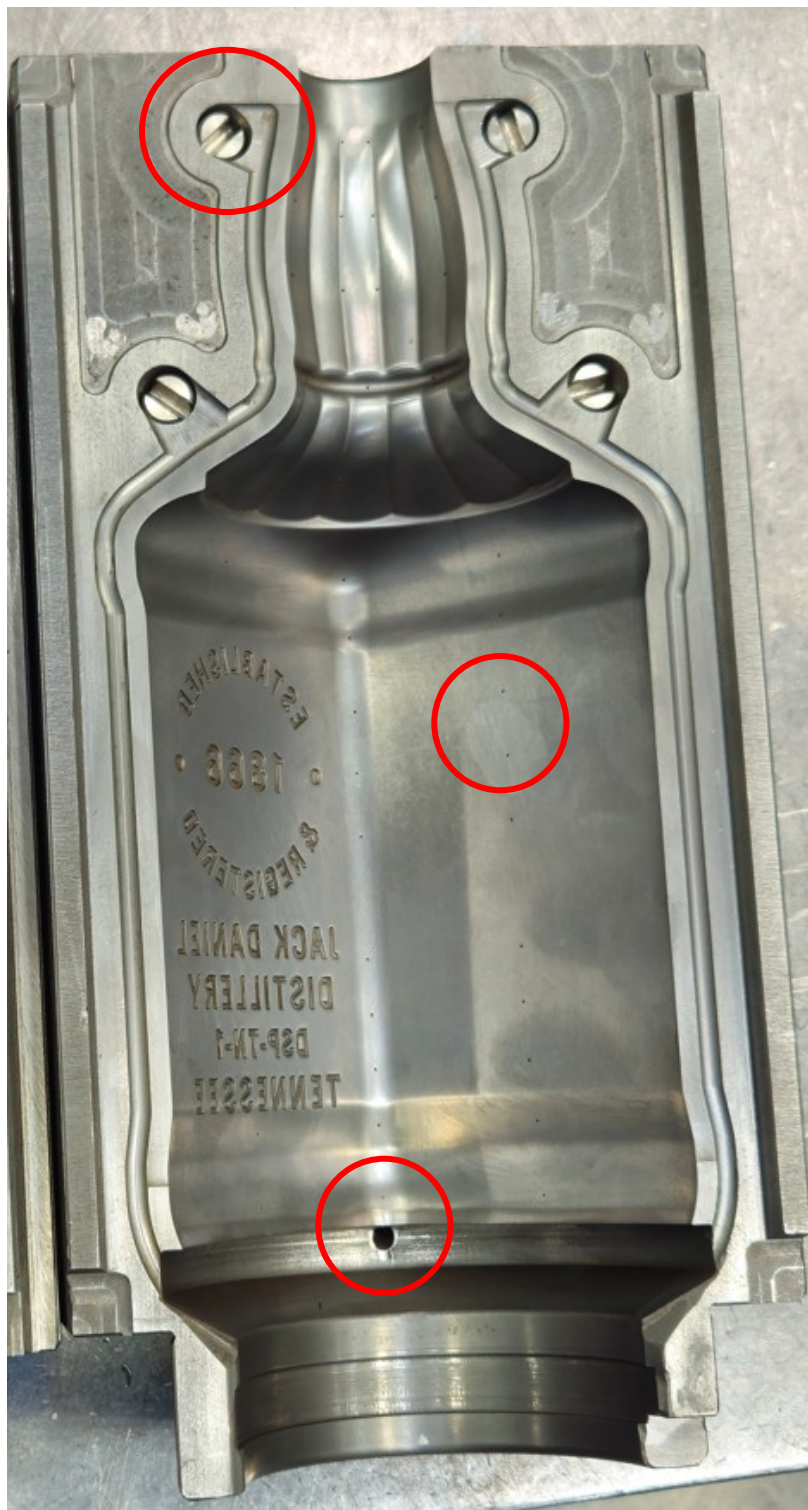
Slika 97. Prikaz vakuum rupa i rupa za hlađenje
