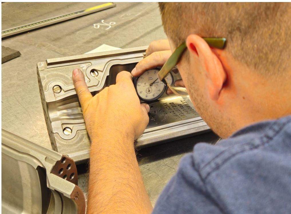
Slika 94. Mjerenje dubine gravure
