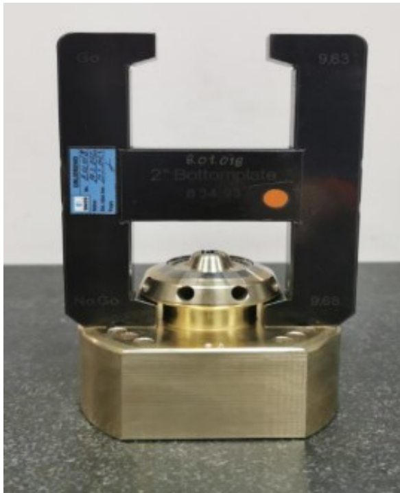
Slika 51. Postupak mjerenja kosine prizme na dnu kalupa [16]
