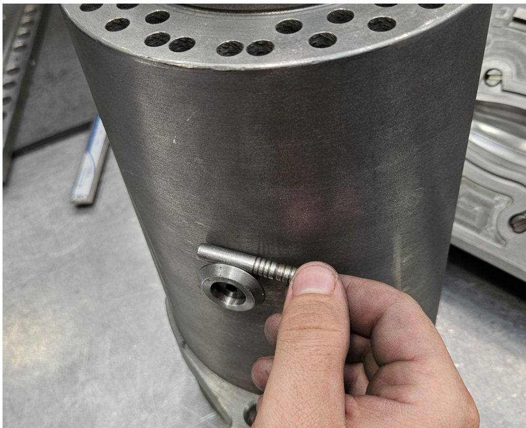
Slika 103. Kalibar za mjerenje zračnosti segmenta
