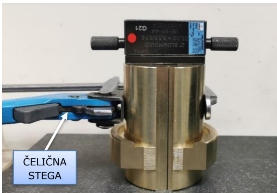
Slika 46. Primjer stezanja i postavljanja kalibra za mjerenje visine prizme [15]
