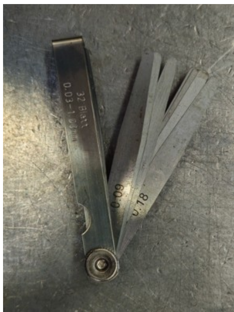
Slika 83. Listići za mjerenje zračnosti
