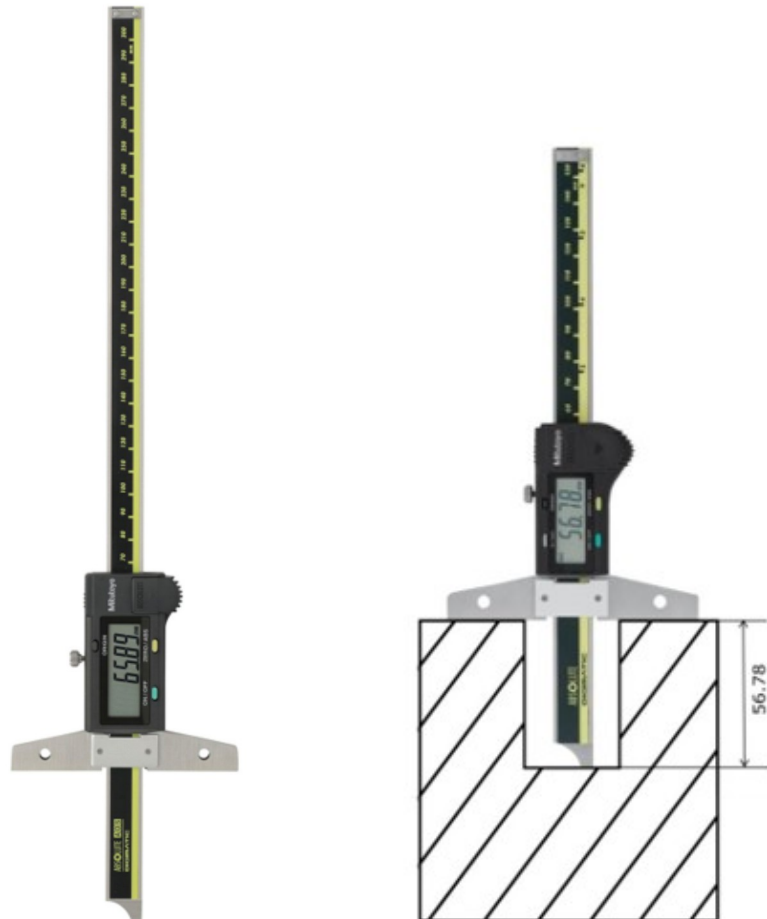
Slika 36. Dubinomjer i primjer mjerenja [12]
