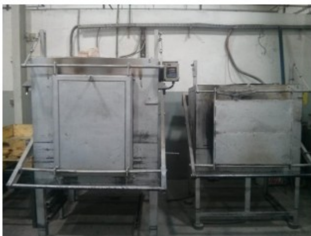
Slika 25. Električna peć i šamotna kutija [11]
