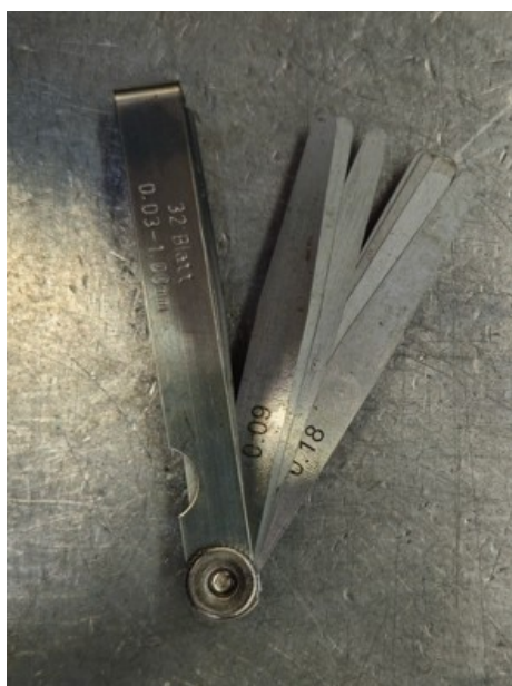
Slika 83. Listići za mjerenje zračnosti
