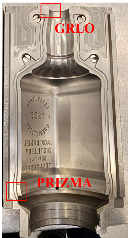
Slika 84. Mjerenje zračnosti unutarnje stijenske na grlu i prizmi
