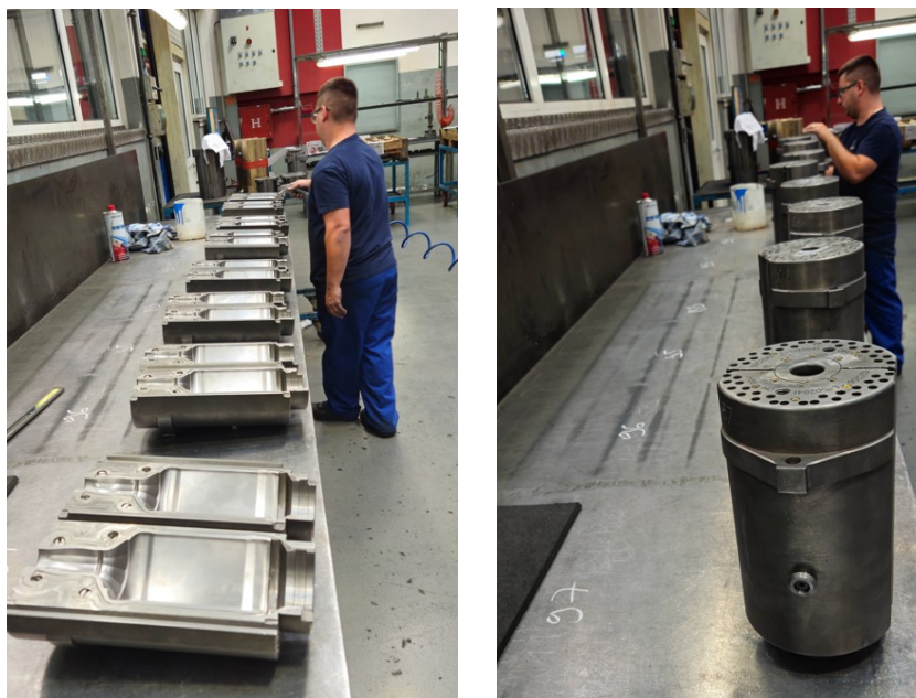
Slika 60. Čišćenje kalupa i ispisivanje brojeva kredom na stol
