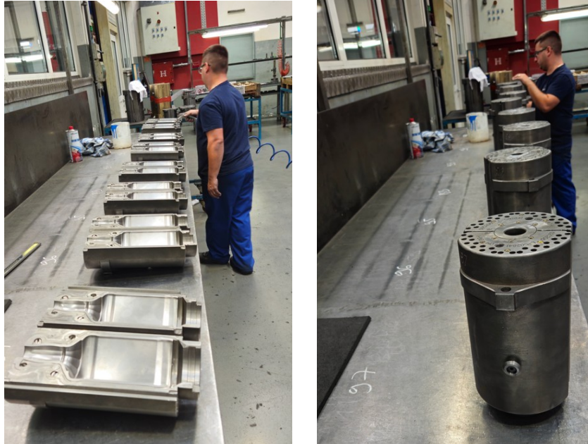
Slika 60. Čišćenje kalupa i ispisivanje brojeva kredom na stol
