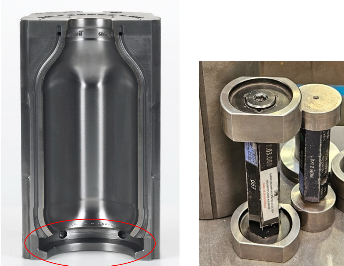
Slika 42. Položaj prizme i primjer kalibra za mjerenje prizme [15]
