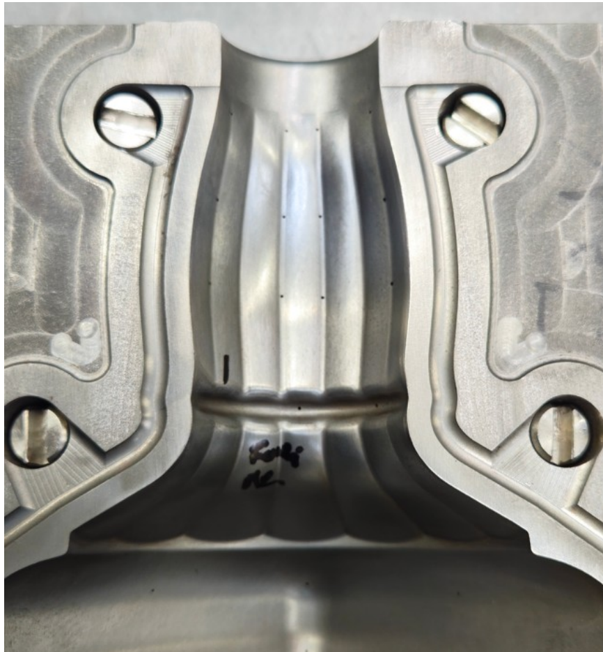
Slika 101. Nedostaje rupica za hlađenje na vratu unutarnje stijenke
