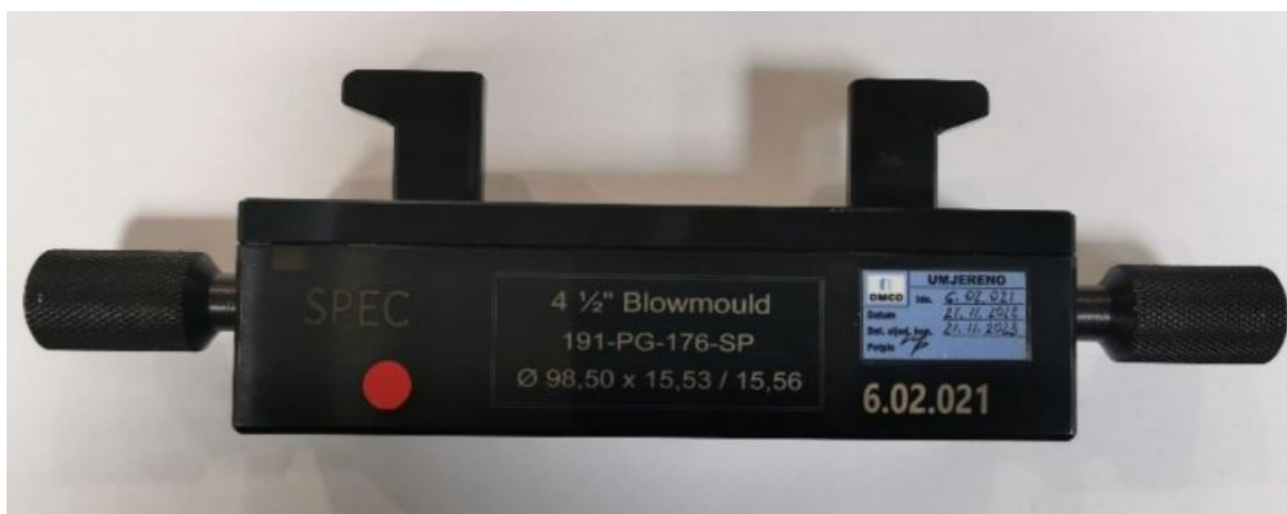
Slika 45. Kalibar za mjerenje visine prizme [15]
