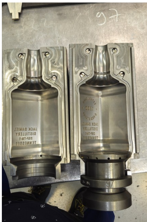
Slika 87. Sklop kalupa i dna
