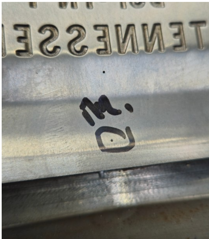
Slika 102. Začepljena rupica za hlađenje na dnu unutarnje stijenke
