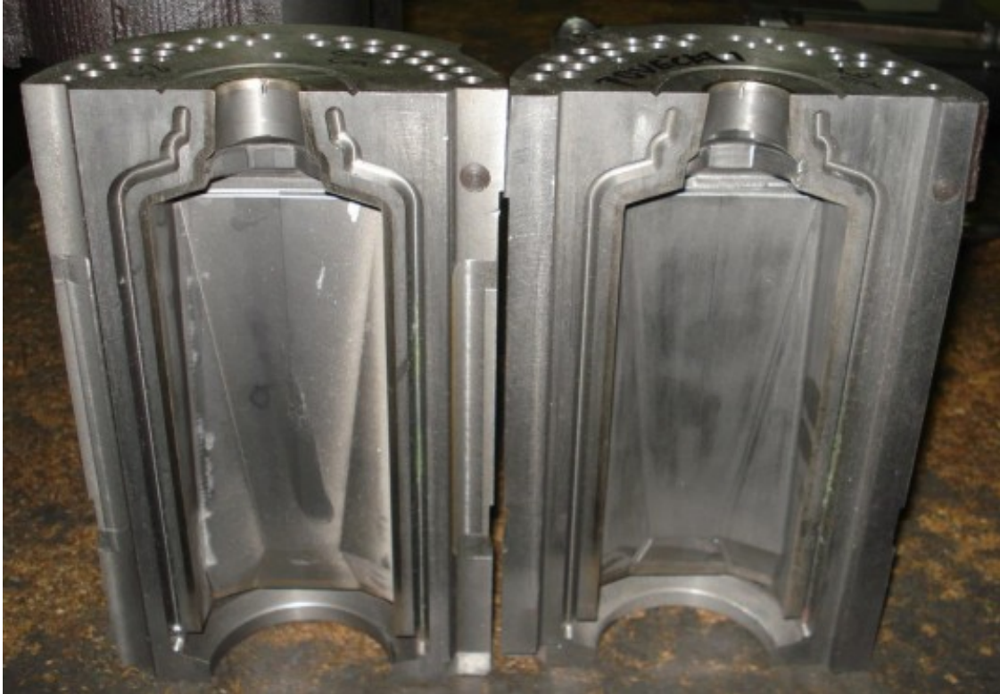
Slika 31. Glodanje nepravilnog oblika unutarnje stijenke kalupa [11]
