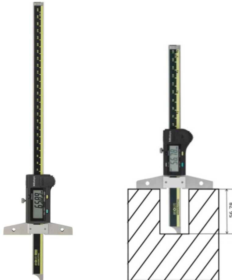
Slika 36. Dubinomjer i primjer mjerenja [12]
