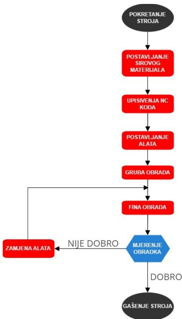
Slika 5. Dijagram toka kod procesa glodanja [6]
