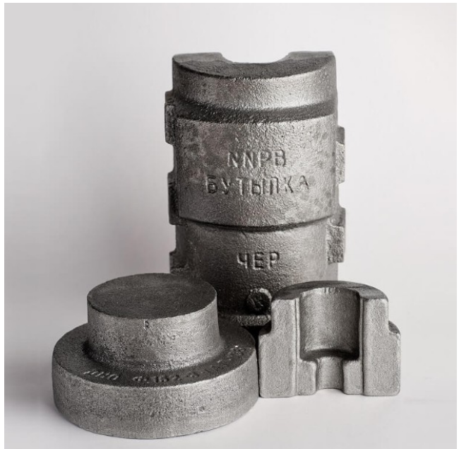
Slika 22. Bronca i sivi lijev [9]
