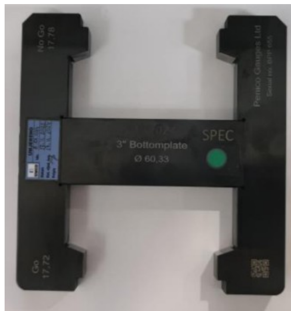
Slika 50. Kalibar za mjerenje kosine prizme na dnu kalupa [16]
