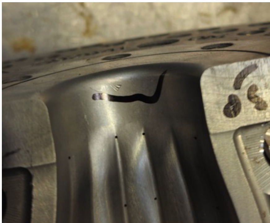
Slika 95. Oštećenje na grlu unutarnje stijenke
