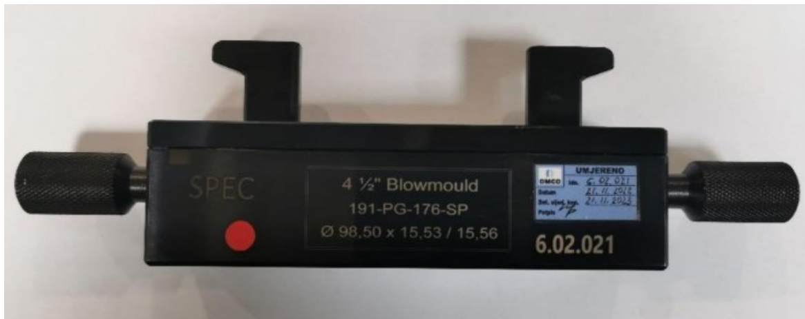
Slika 45. Kalibar za mjerenje visine prizme [15]
